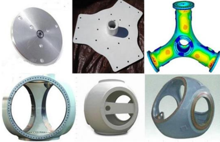
Şekil 4.16. Yatay eksenli rüzgar türbinleri için farklı göbek elemanlar (Demirci, 2011)
