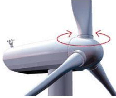
Şekil 4.14. Pitch kontrol sistemiyle kanat hareketi (Kaya, 2014)
