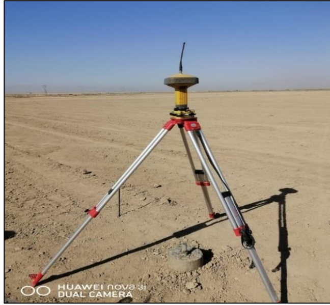
Şekil 3.2. DGPS- RTK ‘nın İkincil Noktaya sabitlenmesi.
