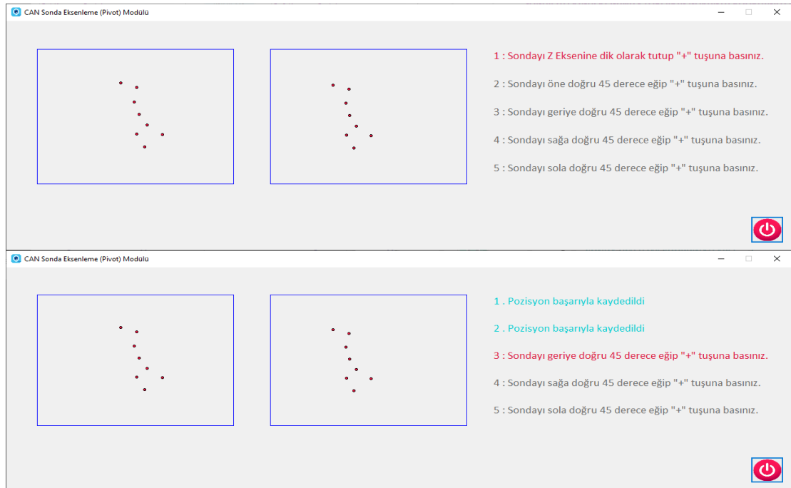
Şekil 5.44. Sonda Ucu Eksenleme (Pivot) Modülü
