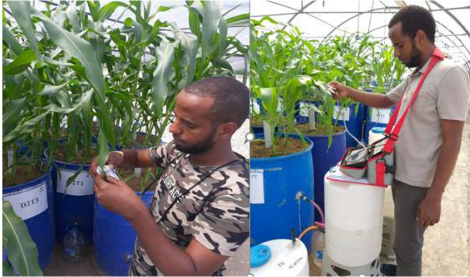
Şekil 3.9. Deneme ölçümleri (a) klorofil ölçümü (b) stoma iletkenliği ölçümü
