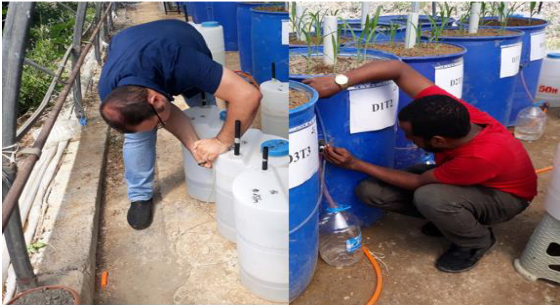
Şekil 3.6. Lizimetrelerde Sabit Tabansuyu Seviyesinin Korunması
