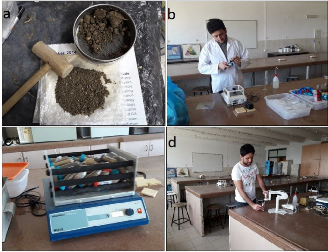
Şekil 1.10. Toprak örneklerinin jeostatiksel özelliklerinin ortaya konulması amacıyla laboratuvar çalışmaları yapılmıştır. a) Toprak örneklerinin elenmesi b) Toprak örneklerinin tartılması. c) Toprak örneklerinin karıştırılması d) Toprak örneklerinin pH ölçümü
