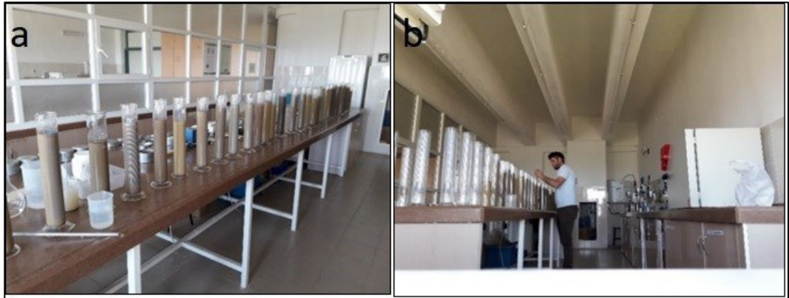
Şekil 1.12. Toprak örneklerinin jeostatiksel özelliklerinin ortaya konulması amacıyla yapılan laboratuvar çalışmaları – 3. a) Hidrometre Yöntemi'nin uygulanması - 1 b) Hidrometre Yöntemi'nin uygulanması – 2
