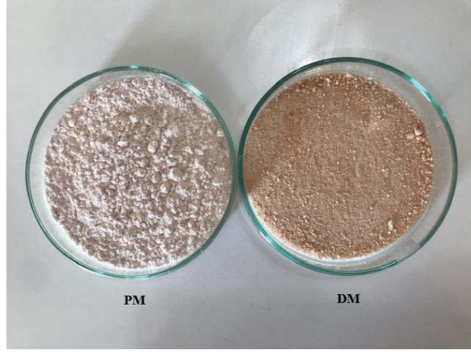
Şekil 4.15. Püskürtmeli kurutma yöntemi ile elde edilmiş mikrokapsül (PM) ve dondurarak kurutma yöntemi ile elde edilmiş mikrokapsül (DM)
