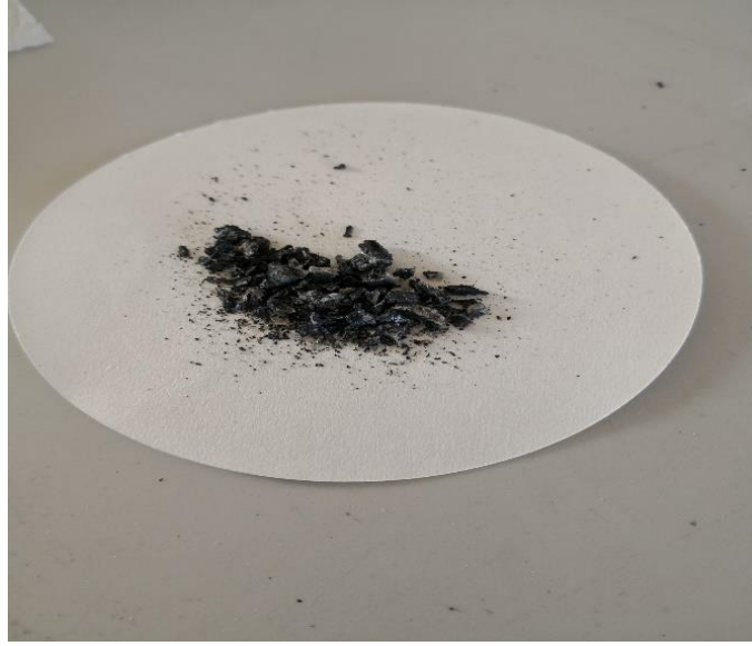
Şekil 8.3. Elektrolizden sonra katot elektrot üzerinden alınan karbon nanofiber
