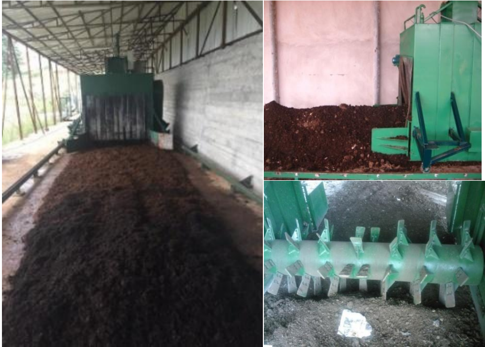
Şekil 3.5. Çay atıklarının kompostlanmasında kullanılan windrow kompostlayıcı
