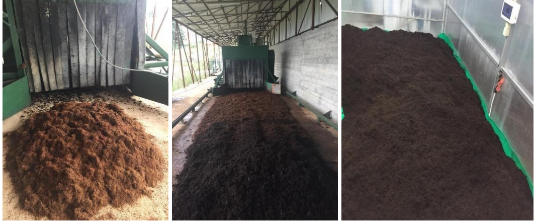
Şekil 4.1. Çay atıklarının kompostlanmasında kullanılan windrow kompostlayıcı ve kompost eldesi
