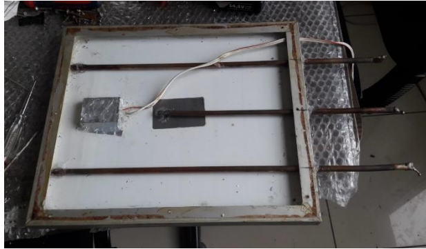
Şekil 2.3. Isı borularının yerleştirilme prensibi
