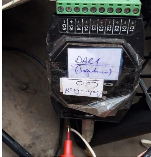
Şekil 2.7. Deney esnasında verilerin alındığı data logger cihazı
