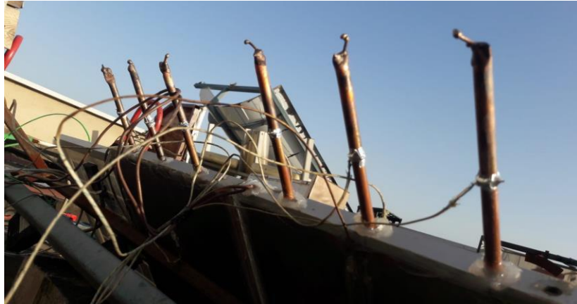
Şekil 1.7. Yerçekimi destekli ısı boruları (bu çalışmada yapılmıştır).
