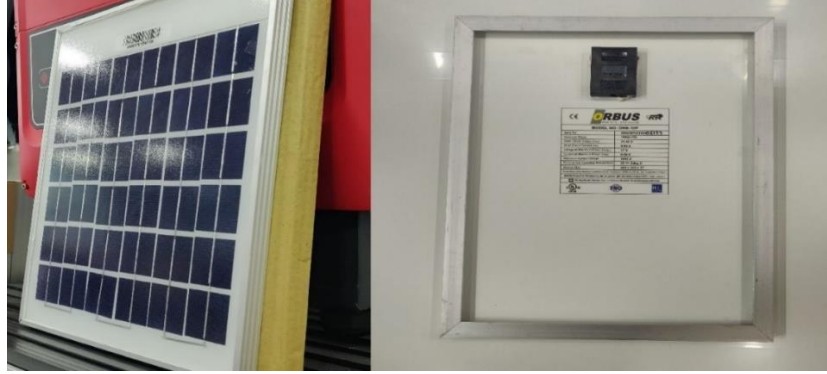
Şekil 2.8. Deneyde kullanılan temel haldeki panelin ön ve arka yüzü
