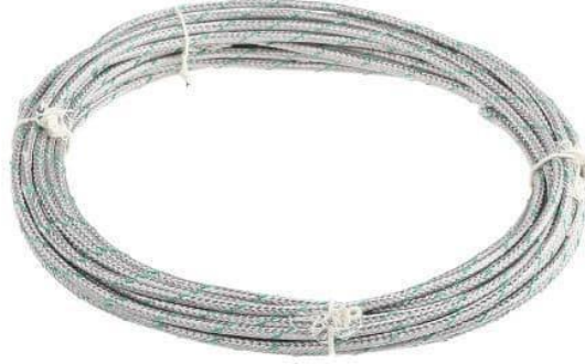
Şekil 2.9. Deneyde kullanılan K tipi termočift
