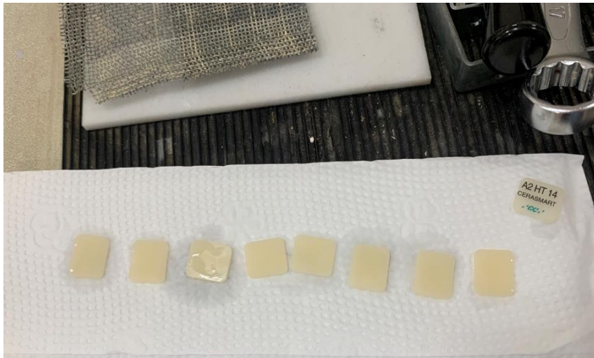
Şekil 3.9. CAD-CAM blokların kesildikten sonra kurutması
