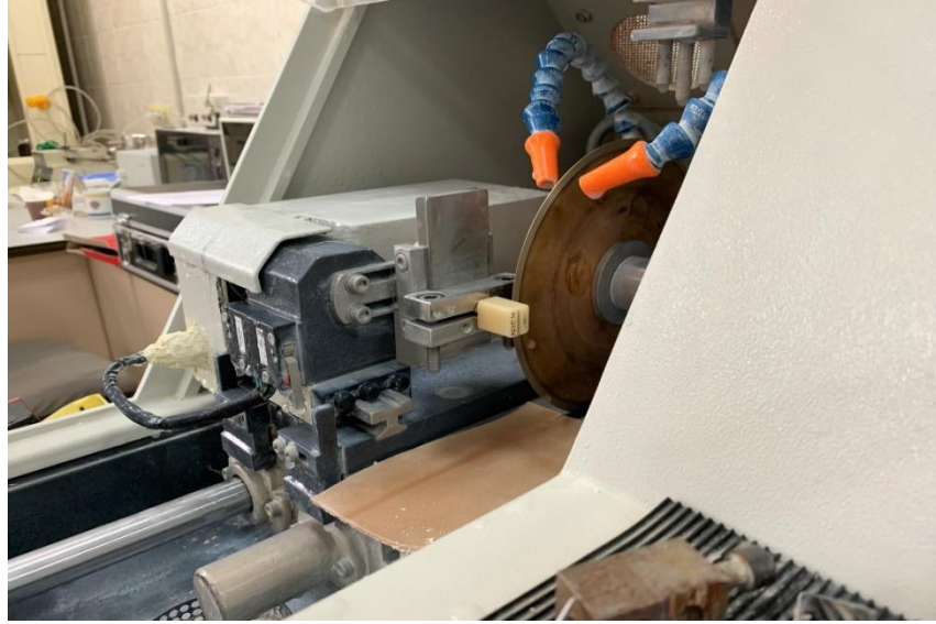
Şekil 3.7. CAD-CAM blokların kesme cihazına yerleştirilmesi
