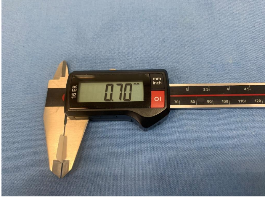
Şekil 3.12. Dijital kumpas ile numunelerin kalınlının kontrol edilmesi
