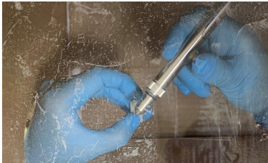
Şekil 3.15. Numunelerin yüzeyi, kumlama cihazıyla pürüzlendirilmesi
