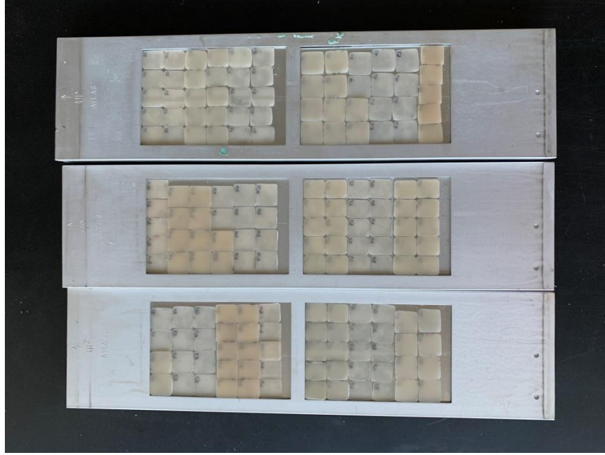
Şekil 3.28. Numunelerin UV yaşlandırma cihazına yerleştirilmesi
