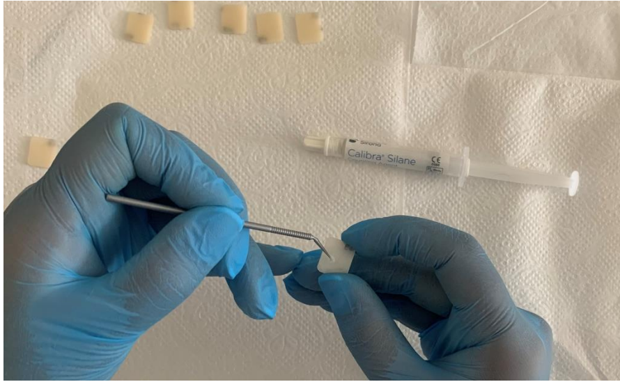
Şekil 3.17. Hazırlanan numunelerin arka yüzeylerine silan uygulanması
