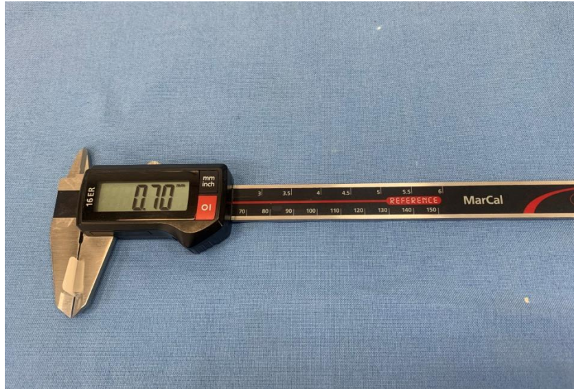
Şekil 3.24. Örneklerin kalınlığı, dijital kumpasla ölçülmesi
