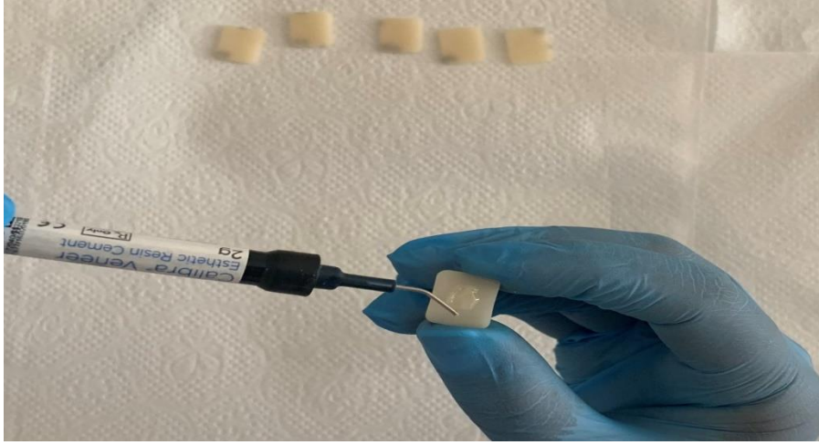
Şekil 3.21. Numunelere siman uygulanması
