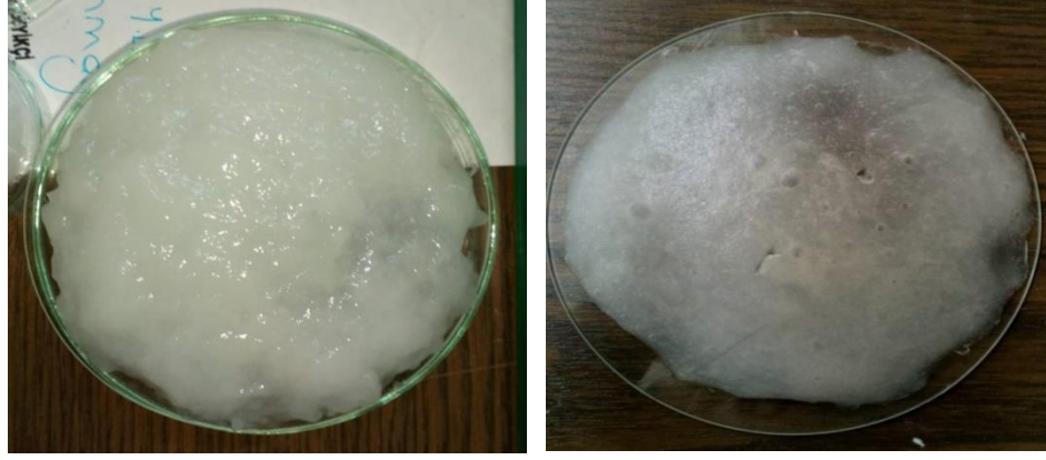
Şekil 4. 8. HPMC-Niřasta yapısında sorbitol kullanımı ve kuru film
