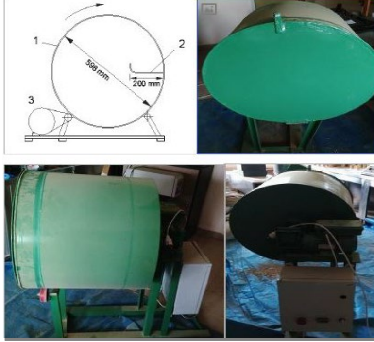
Şekil 3.8. Mekanik dayanıklılık test düzeneği
