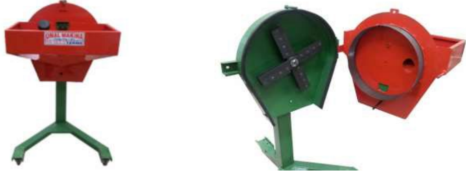
Şekil 3.3. Trabzon hurması budama atıklarının farklı öğütülme incelikleri için kullanılan çekicli değirmen
