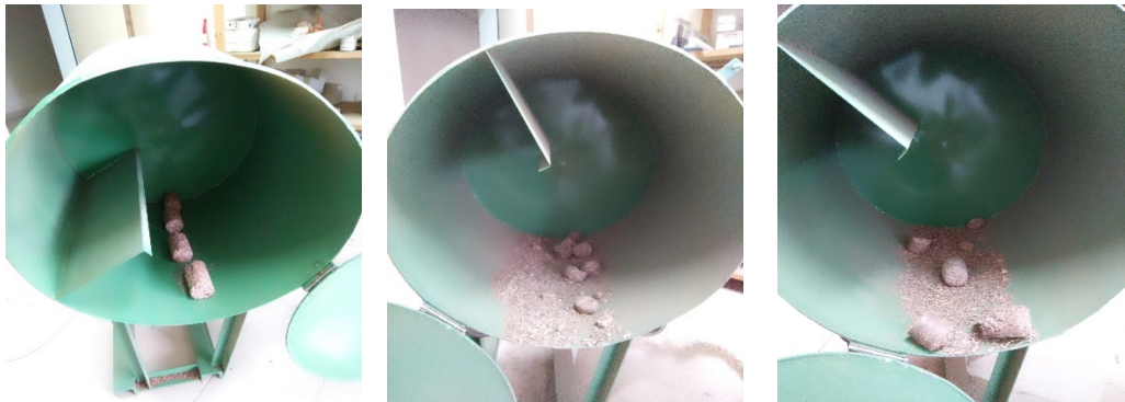
Şekil 3.20. Dayanıklılık (tumbler) test düzeneği
