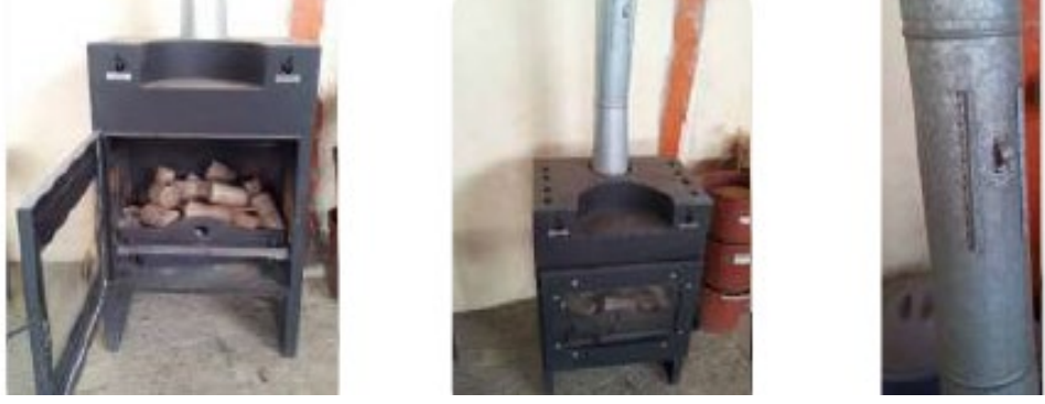
Şekil 3.11. Briketlerin yakılması için kullanılan şömine tipi soba
