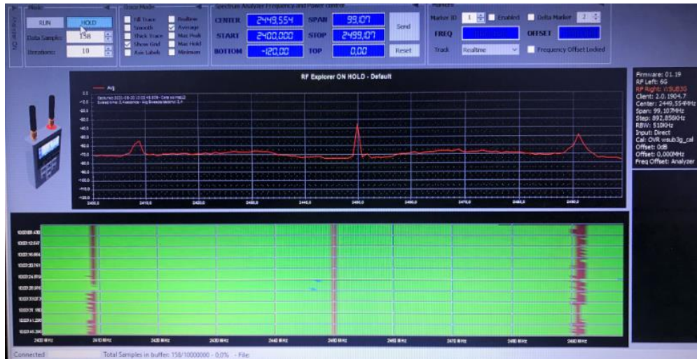
Şekil 3.3 Spektrum analiz cihazında 2,45 GHz sinyal frekansının doğrulanması
