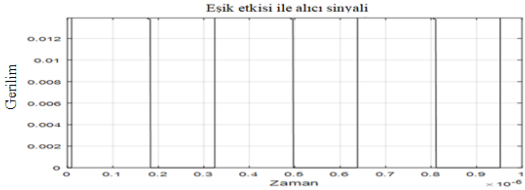
Şekil 4.55. Eşik etkisi ile verici ve alıcının (1.5, 2.5, 3) ve (1.5, 2.5, 0) konumlarında durum 4'ün alıcı sinyali
