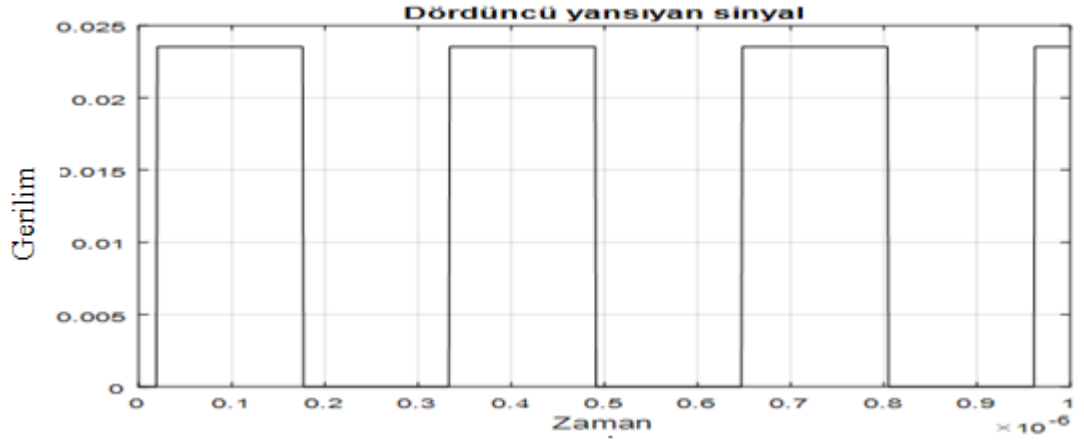
Şekil 4.51. Verici ve alıcının (1.5, 2.5, 3) ve (1.5, 2.5, 0) konumlarında durum 4'ün dördüncü yansıyan sinyali
