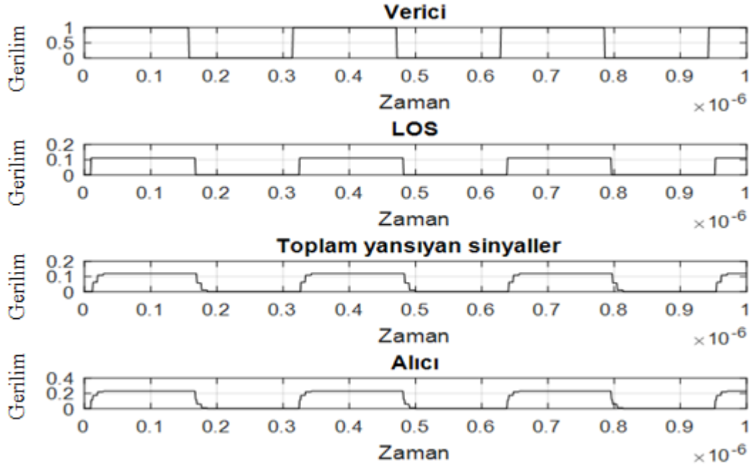
Şekil 4.43. Verici ve alıcının (1, 2.5, 3) ve (1, 2.5, 0) konumlarında durum 3'ün dört duvarı için yansıyan sinyallerin çoklu yol etkisi
