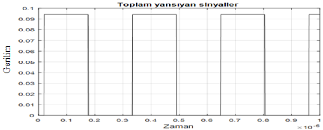
Şekil 4.25. Verici ve alıcının (2.5, 2.5, 3) ve (2.5, 2.5, 0) konumlarında durum 2'nin toplam yansıyan sinyalleri
