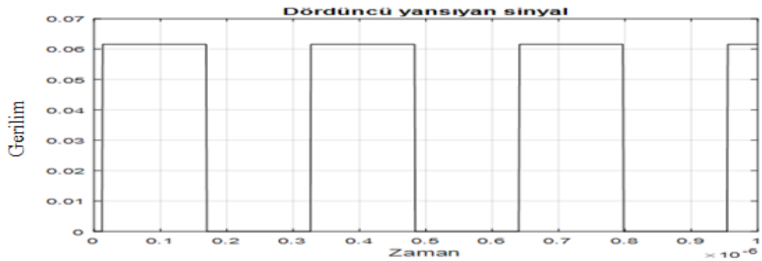
Şekil 4.7. Verici ve alıcının (2, 1, 3) ve (2, 1, 0) konumlarında durum 1'in dördüncü yansıyan sinyali
