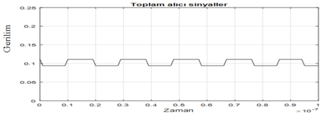
Şekil 4.32. OOK'nin maksimum verici hızını belirlemek için verici ve alıcının (2.5, 2.5, 3) ve (2.5, 2.5, 0) konumlarında 2 durumdaki alıcı sinyali
