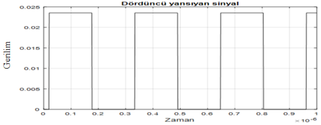
Şekil 4.40. Verici ve alıcının (1, 2.5, 3) ve (1, 2.5, 0) konumlarında durum 3'ün dördüncü yansıyan sinyali
