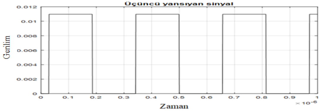
Şekil 4.6. Verici ve alıcının (2, 1, 3) ve (2, 1, 0) konumlarında durum 1'in üçüncü yansıyan sinyali
