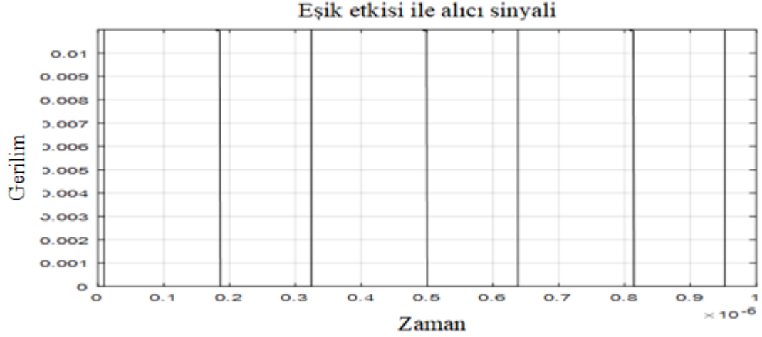
Şekil 4.11. Eşik etkisi ile verici ve alıcının (2, 1, 3) ve (2, 1, 0) konumlarında durum 1'inalıcı sinyali
