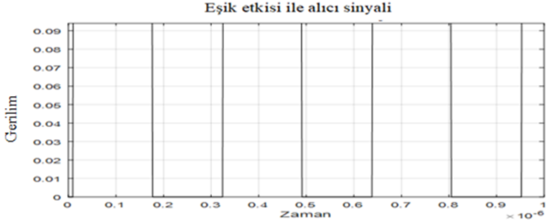
Şekil 4.28. Eşik etkisi ile verici ve alıcının (2.5, 2.5, 3) ve (2.5, 2.5, 0) konumlarında durum 2'nin alıcı sinyali
