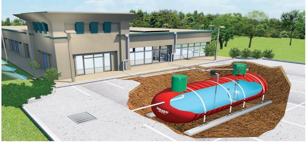
Şekil 3.16. Yağmur Suyu Toplama Sistemleri (Plomeriaengineers, 2020)
