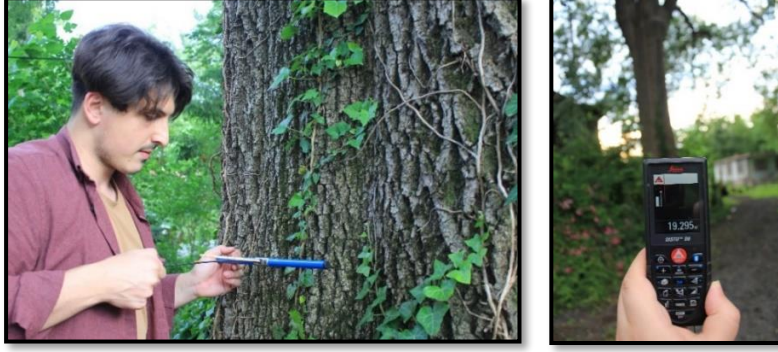
Şekil 2.2. Artım Burgusu ile örnek alınması (solda), Boy ölçümünde kullanılan lazermetre (sağda)
