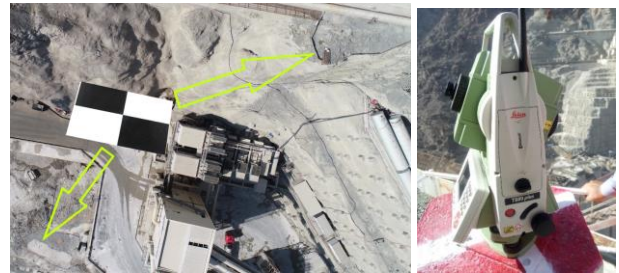
Şekil 4. Çalışma sahası YKN levhaları ve Leica TS09 Plus ile YKN ölçümü
