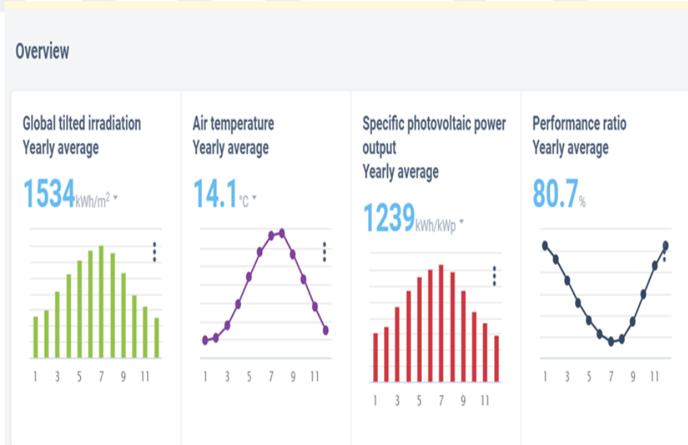
Şekil 4.27. Optimize edilmiş açılı ve gölgesiz bir FV sistemin performansı için yıllık oran, hava sıcaklığı özel FV güç çıkışı ve performans oranı.
