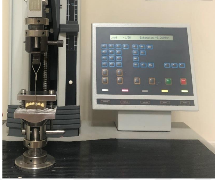
Şekil 3.6 Esneme testinin gerçekleştirildiği cihaz ve özel tasarlanan test düzeneği
