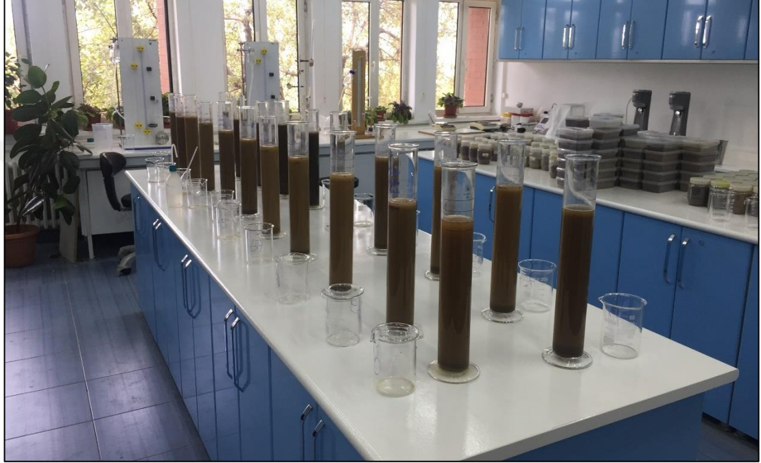
Şekil 2.9. Hidrometre okuması yapılmak üzere örneklerin sedimentasyon silindirinde bekletilmesi
