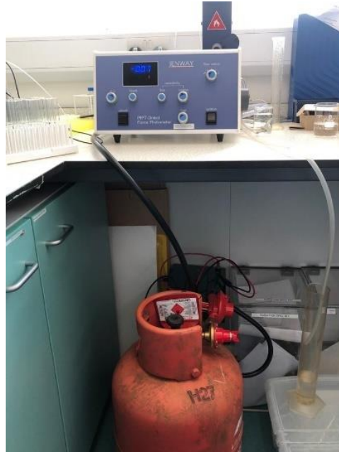
Şekil 3.7. Araştırma methodlarından alev fotometresi
