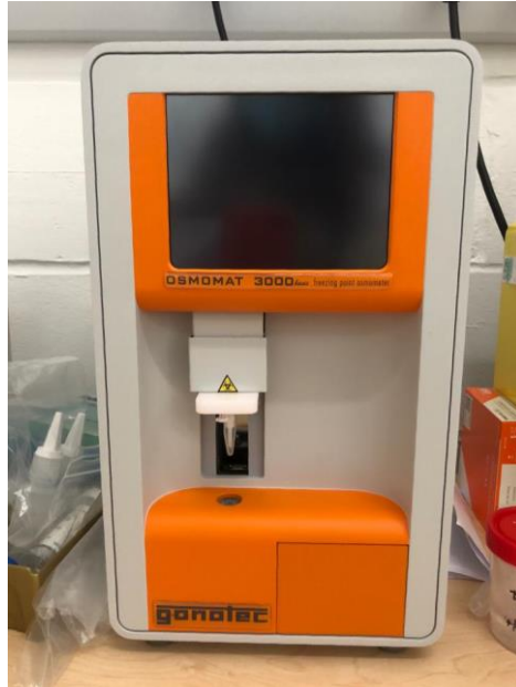
Şekil 3.9. İdrar ozmolalitesi tayini için kullanılan ozmometre
