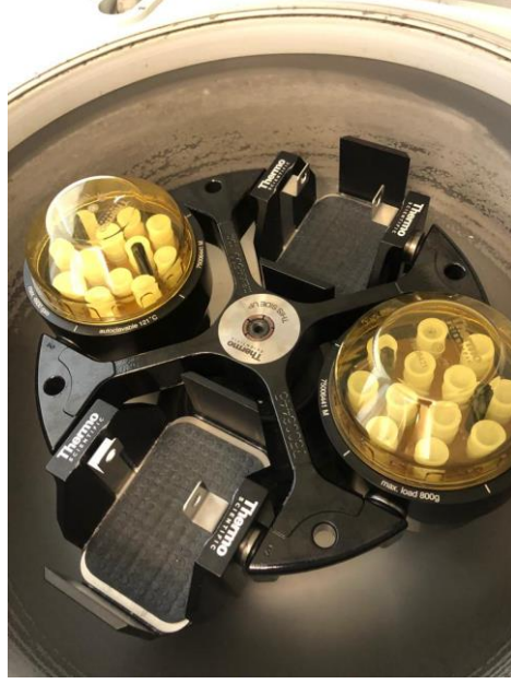
Şekil 3.6. Simetrik şekilde ayarlanan santrifüj makinesi
