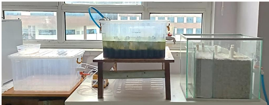
Şekil 3.16. Birleşik arıtım sistemi
