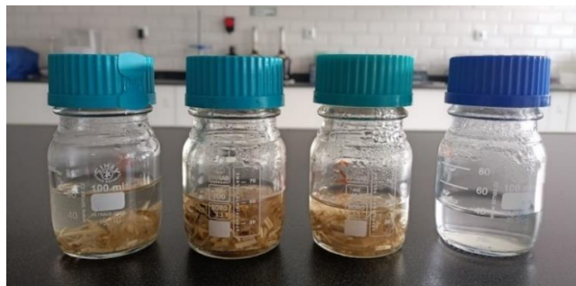
řekil 3.8. Nitrat giderimi iin gerekleřtirilen li deneyleri
