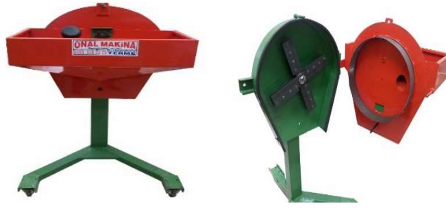
Şekil 3.3. Domates atıklarının (domates atığı ve ön işlem uygulanmış domates atığı) farklı incelikte öğütülmesinde kullanılan çekiçli değirmen
