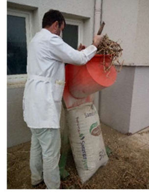
Şekil 3.3. Domates atıklarının (domates atığı ve ön işlem uygulanmış domates atığı) farklı incelikte öğütülmesinde kullanılan çekiçli değirmen
