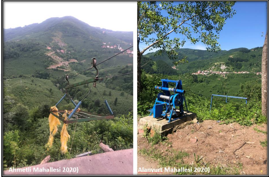
Şekil 4.37. Yörede eğimli araziden findık taşımada kullanılan teleferik sistemleri (2020)
