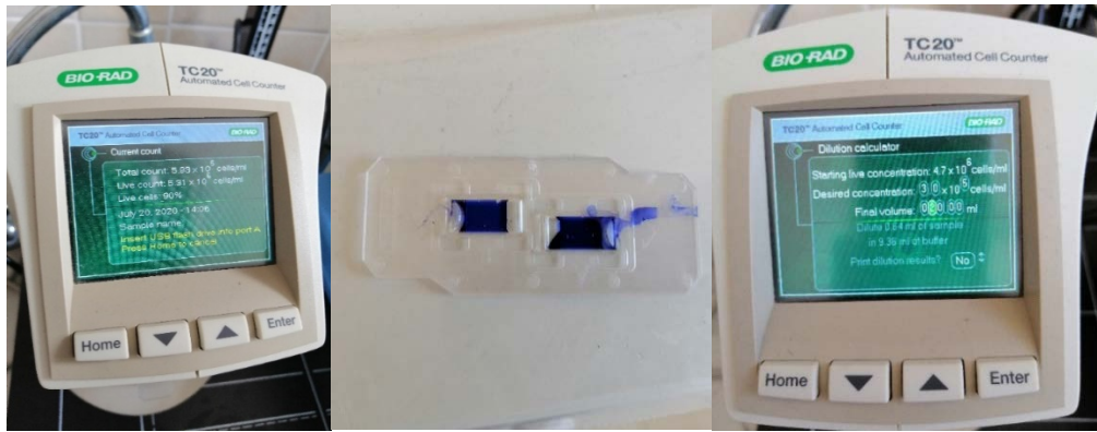
Şekil 3.5. Otomatik hücre sayım cihazında tripan mavisini test yöntemiyle canlı hücre sayımı
