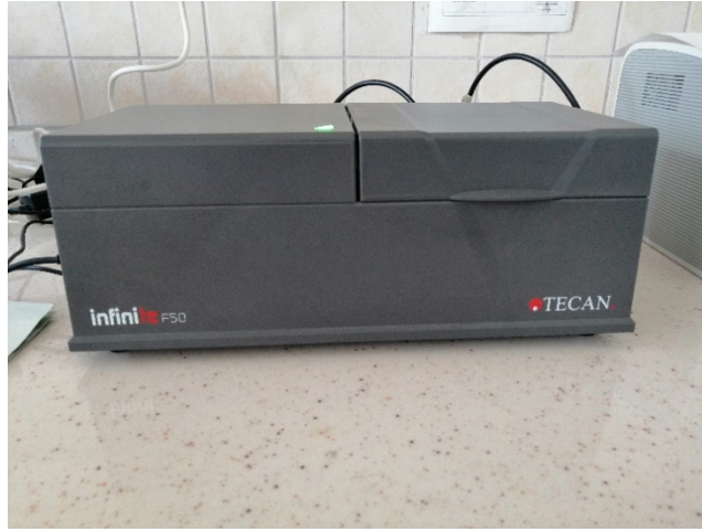
Şekil 3.10. WST-8 yönteminde mikrolaka okuyuculu spektrofotometrede absorbans değeri ölçümü
