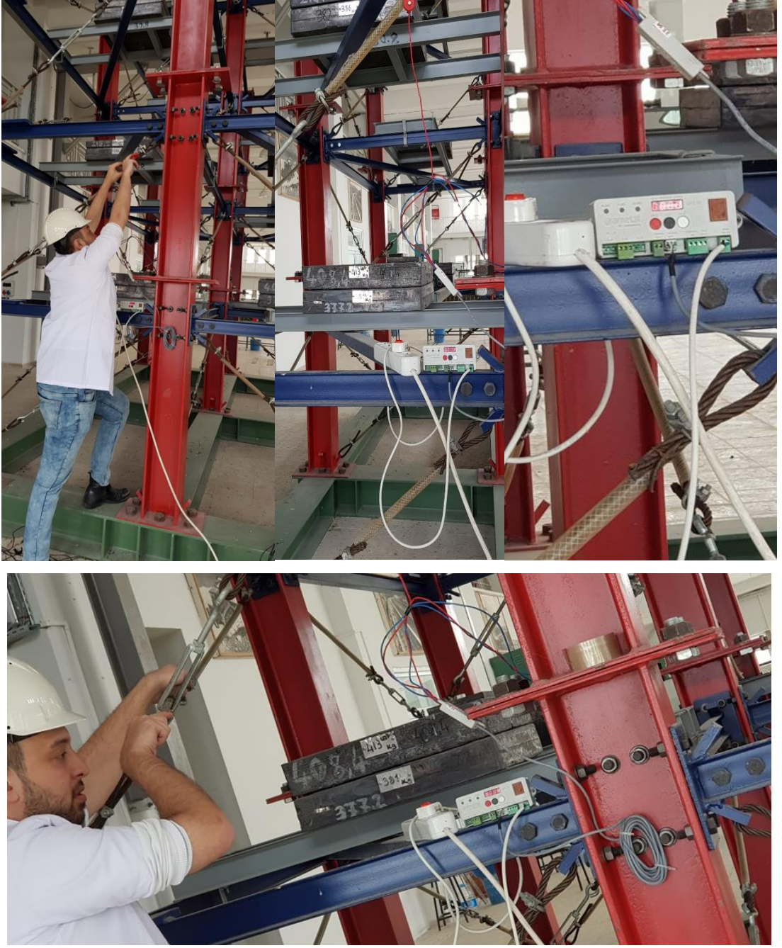
Şekil 4.5. Kablo eleman gerilme kontrolü
