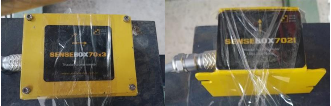
Şekil 4.9. İvmeölçerin yönleri ve sabitlenmesi
