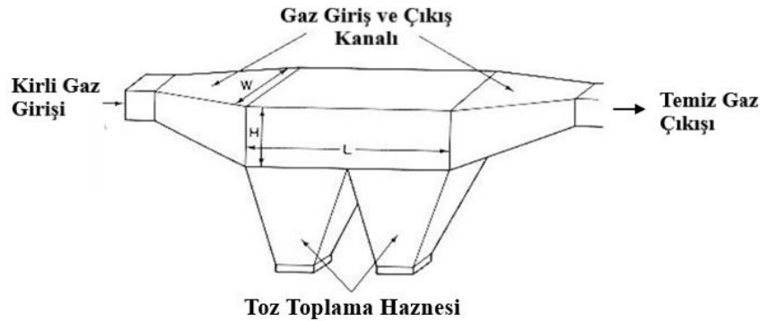
Şekil 2.3. Çökeltme Odası ve Ekipmanları (Theodore, 2008)
