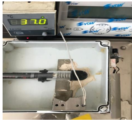
Resim 1. Statik model döngüsel yorgunluk test düzeneğinde metal yapay kanal içeren bloğun monte edildiği plastik kap, termokapıl ve ortamın sıcaklığını ölçen ve ayarlayan termostat izlenmektedir.
