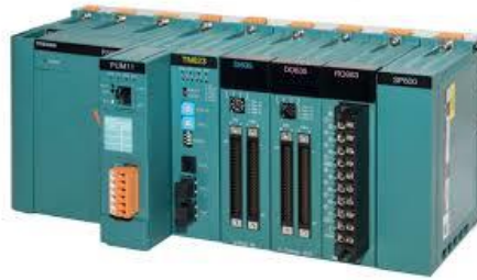
Şekil 1.20. PLC kontrol ünitesi (PLC control panel, 2021)
