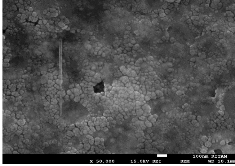
Şekil 4.18. Optimum koşullarda sentezlenen Gümüş nanopartiküllerin SEM mikrografı
