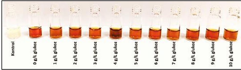
Şekil 4.10. Farklı konsantrasyonlarda glukoz olan besiyerlerindeki renk değişimleri
