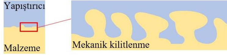
Şekil 2.3. Mekanik kilitlenme mekanizması (Mattson, n.d.)
