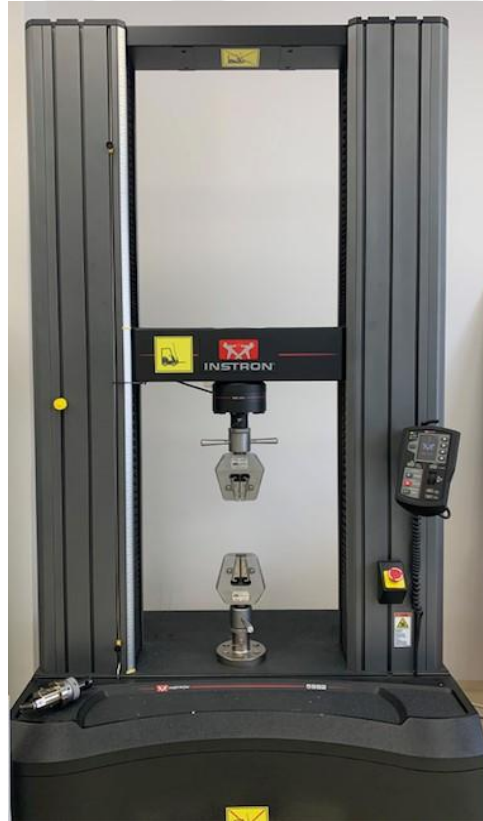
Şekil 3.19. Universal test cihazı (Instron ,3382A, 100kN, USA)
