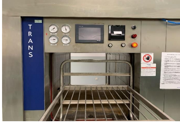
Şekil 3.18. Otoklav cihazı, TRANS GETINGE ‘Smart’, SWEDEN
