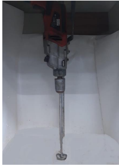
Şekil 3.1. Reaksiyon profili testinde kullanılan Black&Decker marka mekanik karıştırıcı.
