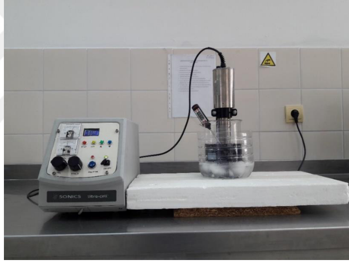
Şekil 4.14. Ultrasonik karıştırma işlemine ait fotoğraf
