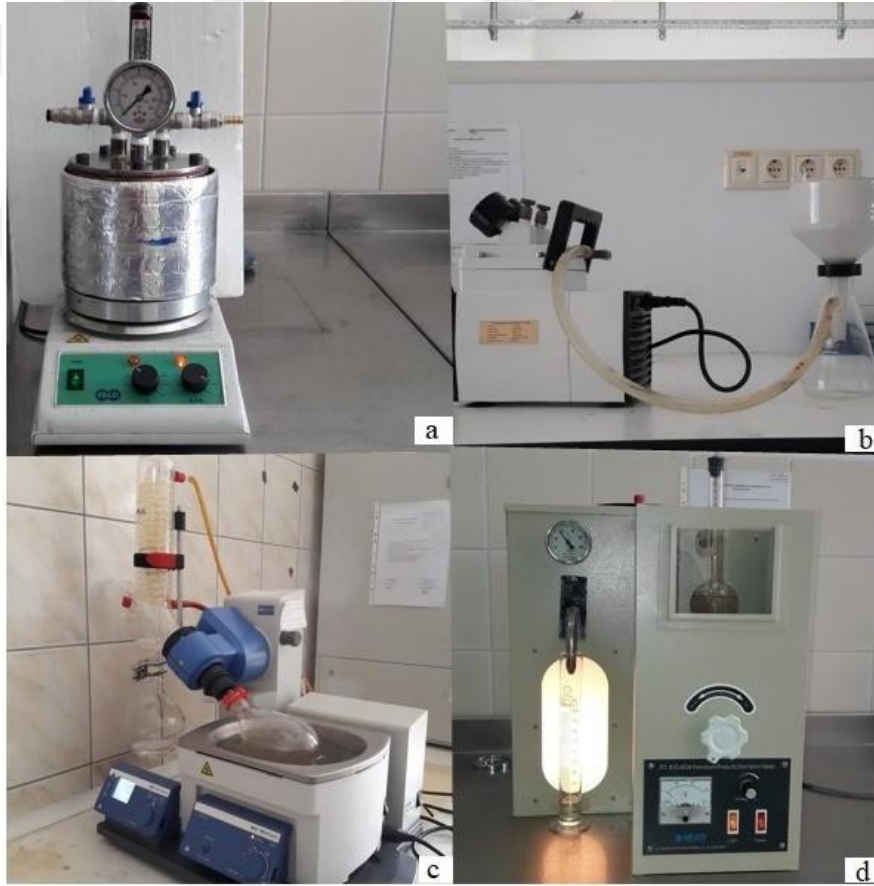
Şekil 4.4. Gliserin tert-bütül eterlerinin üretim aşamalarına ait fotoğraf; (a) Reaksiyon aşaması, (b) Katalizör ayrımı için vakumlu filtrasyon işlemi, (c) Döner tip bulaştırıcıda tert-bütanolün ürünlerden ayrılması, (d) Gliserin eterlerinin ayrımı için uygulanan destilasyon işlemi
