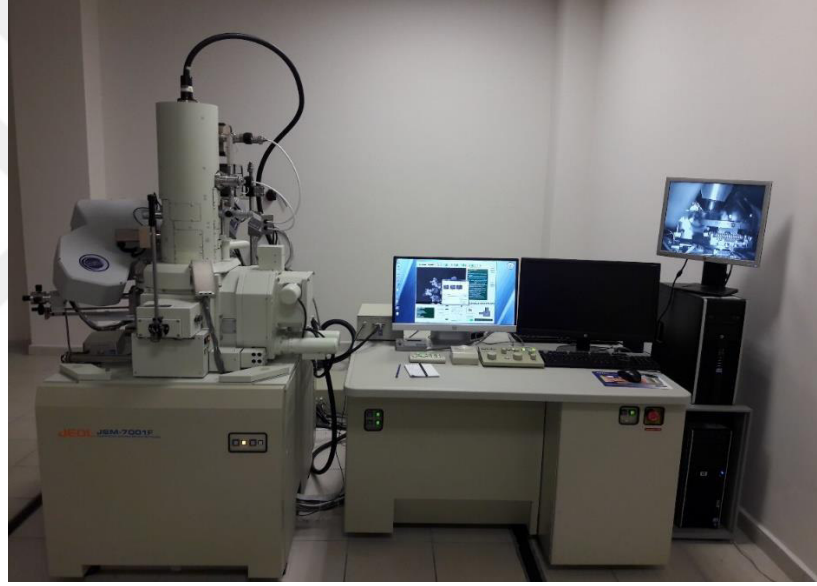
Şekil 4.11. Taramalı elektron mikroskobu
