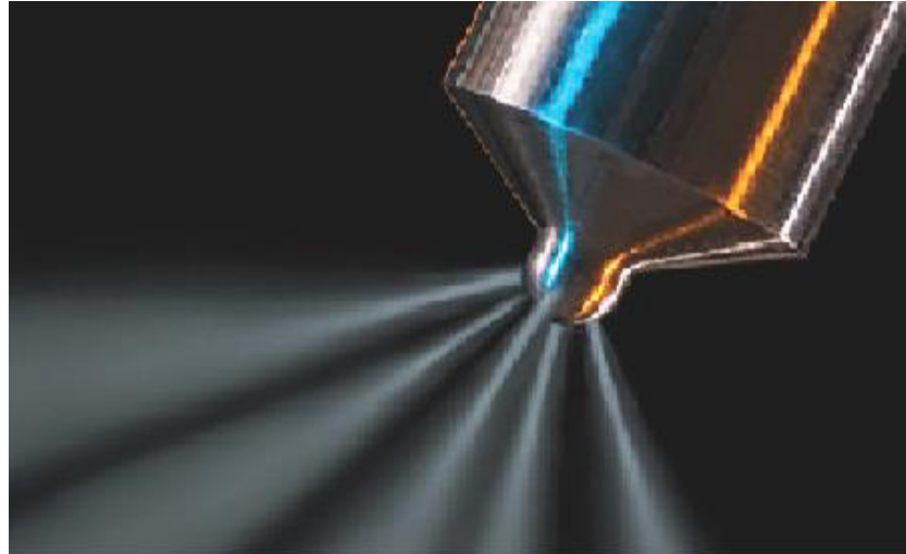
Şekil 3.3. Dizel yakıt demetinin yandan fotoğraflık görünüşü (Anonymous, 2006)
