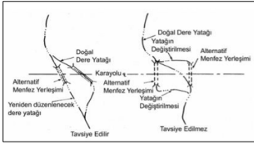
b) Düzenlenmiş dere yatağı üzerinde menfezlerin yerleşimi
