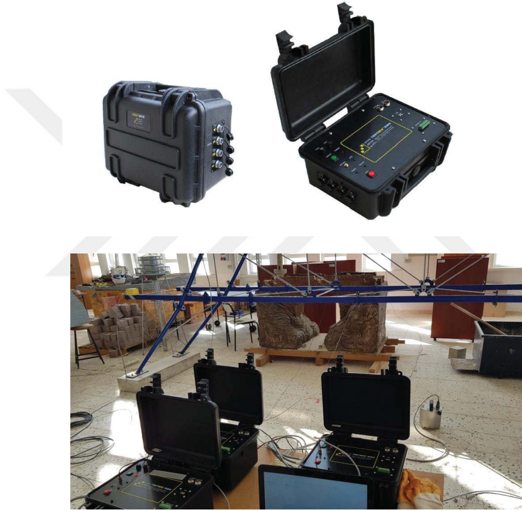
Şekil 3.17. 4 Kanallı dinamik veri toplama cihazı ve ivme kayıt sistemi
