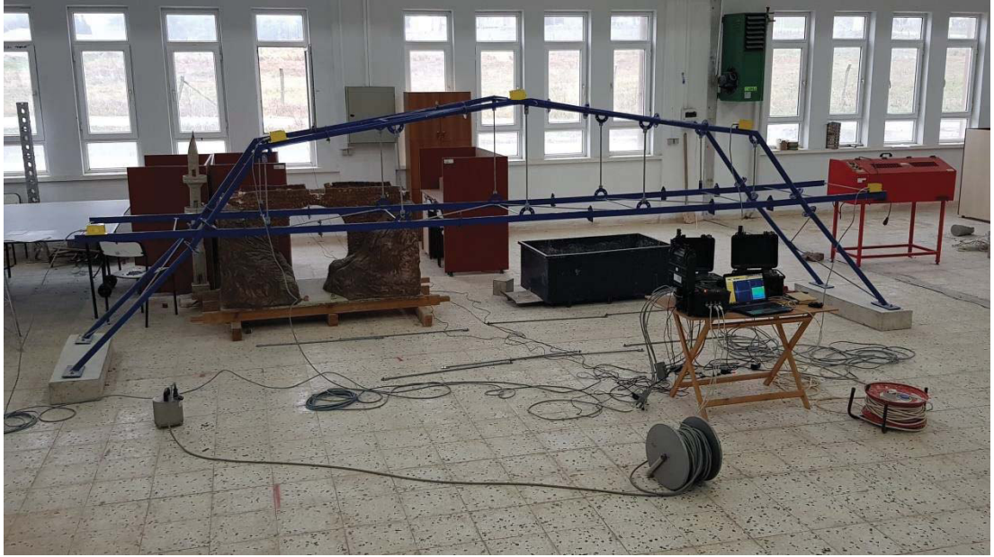
Şekil 4.23. Model çelik köprüde diyagonal sökülmiş hali
