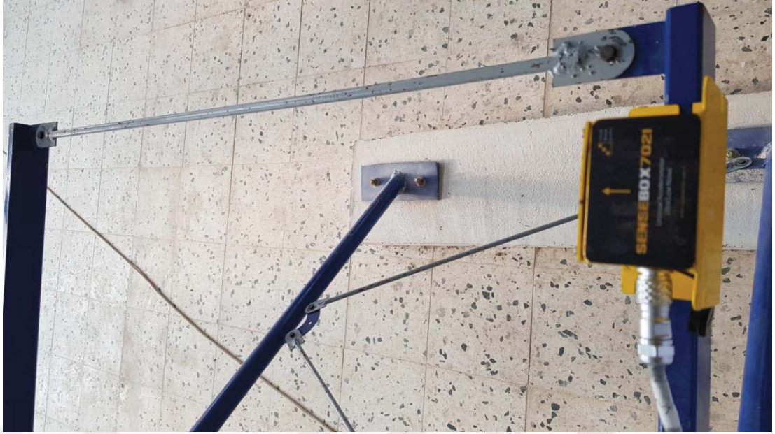
Şekil 4.26 Tek eksenli ivmeölçerin düğüm noktasına yerleştirilmesi
