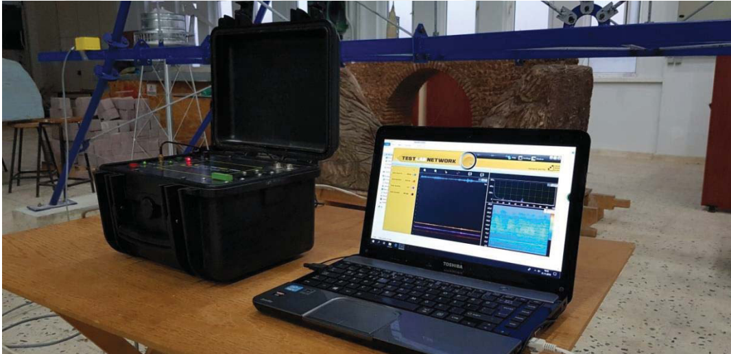
Şekil 4.1. Ölçüm öncesi İvmeölçerlerden veri alınması takibi
