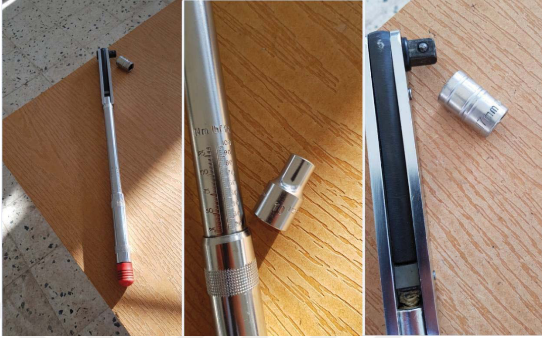
Şekil 3.12. Tez çalışmasında kullanılan tork anahtarı ve başlıklar
