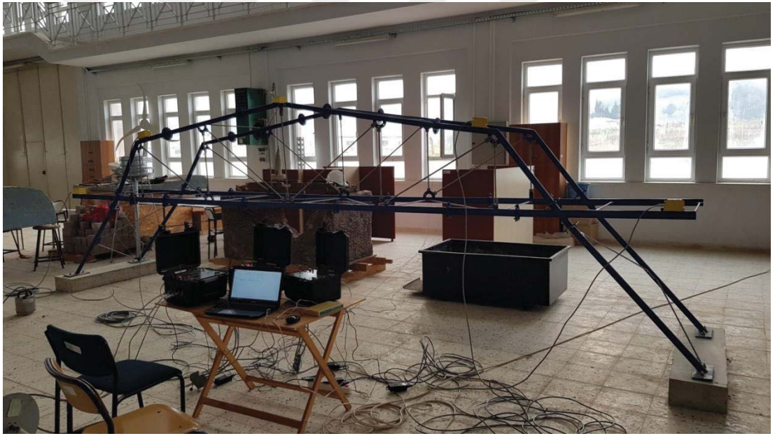
Şekil 4.4. Diyagonalı durum için ivmeölçerler ve sismometre Veri Alınması İşlemi
