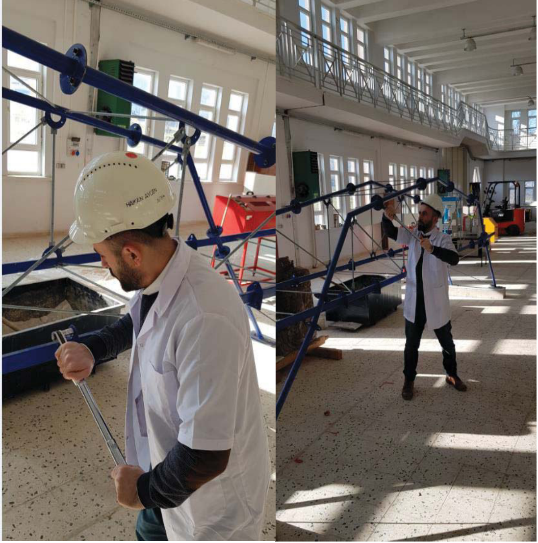
Şekil 3.13-3.14: Model çelik köprünün taşıyıcı elemanlar ve bağlantı elemanlarının tork anahtarı ile sıkılması ve kontrolü
