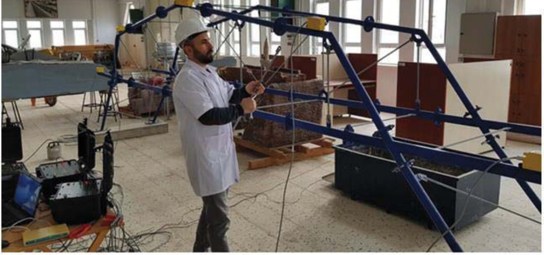
Şekil 4.22. Model çelik köprüde diyagonallerin sökölme işlemleri
