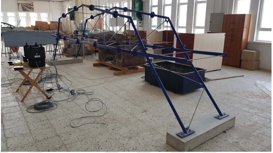
Şekil 3.11. Model çelik köprü mesnet montajlı hali
