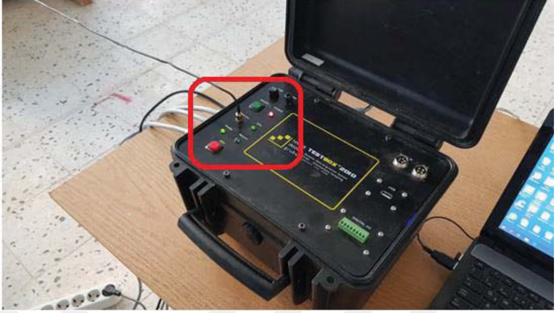
Şekil 3.19. Veri toplama ünitesinin ölçüm uyarıcıları
