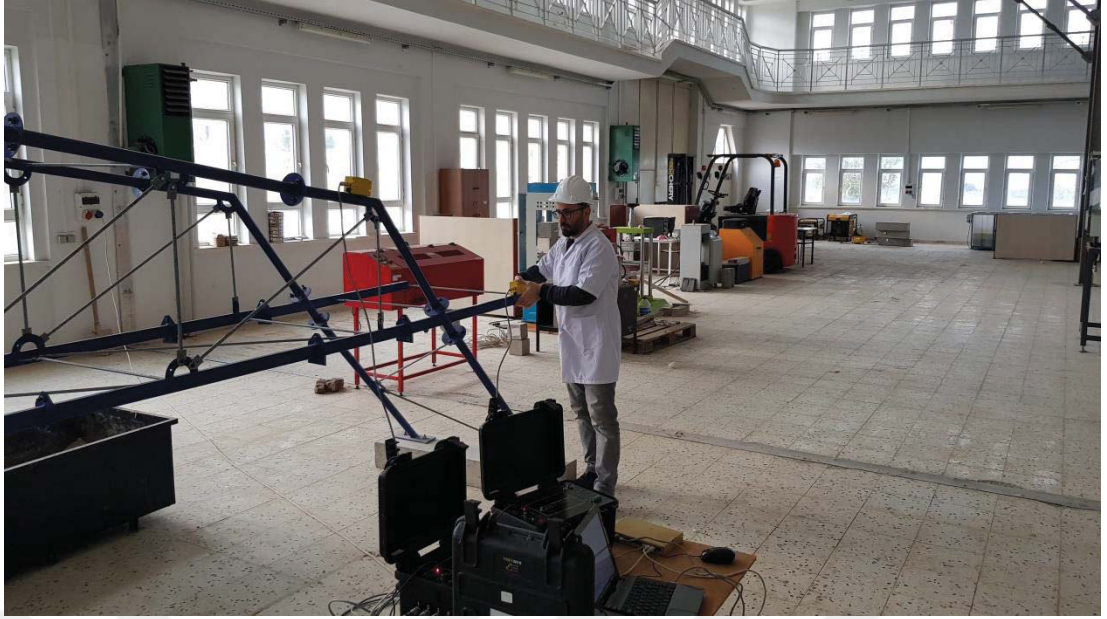
Şekil 4.3. Diyagonalı durum için İvmeölçerlerin Yerleştirilmesi
