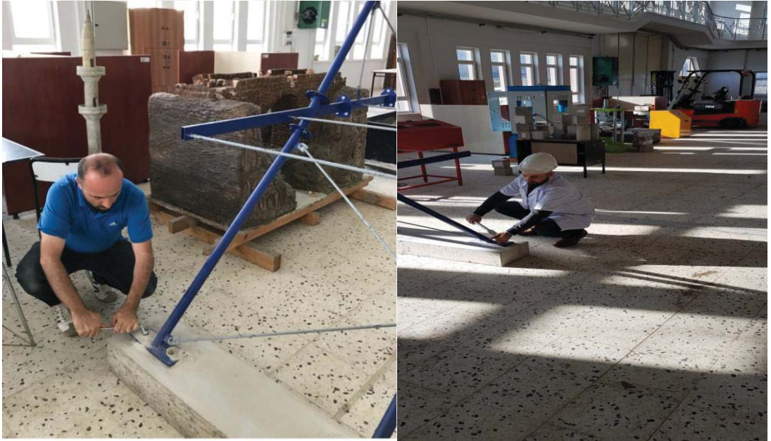
Şekil 3.10. Model çelik köprü ayak montajı
