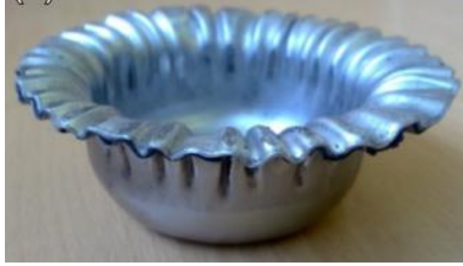
Şekil 4.9. Flanş bölgesinde kırışıklık olan derin çekilmiş parça (Afshin ve Kadkhodayan, 2015)
