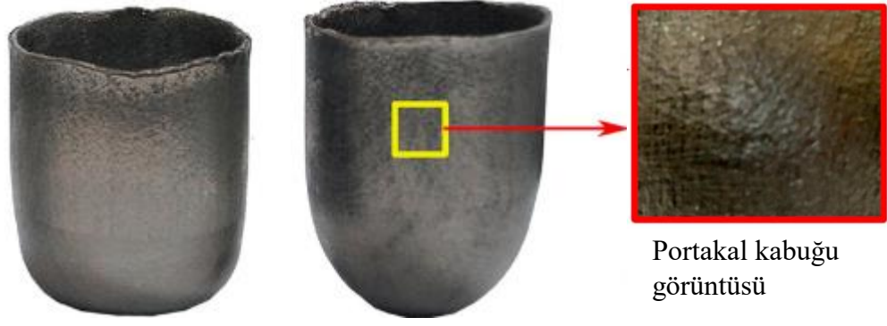
Şekil 4.13. Derin çekilmiş üründeki portakal kabuğu görüntüsü (Prasad vd., 2018)
