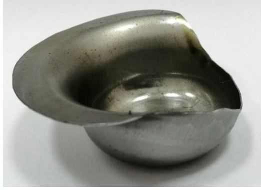
řekil 4.12. Sacın kalıp üzerine yanlıř merkezlenmesi sonucunda oluřan ürün
