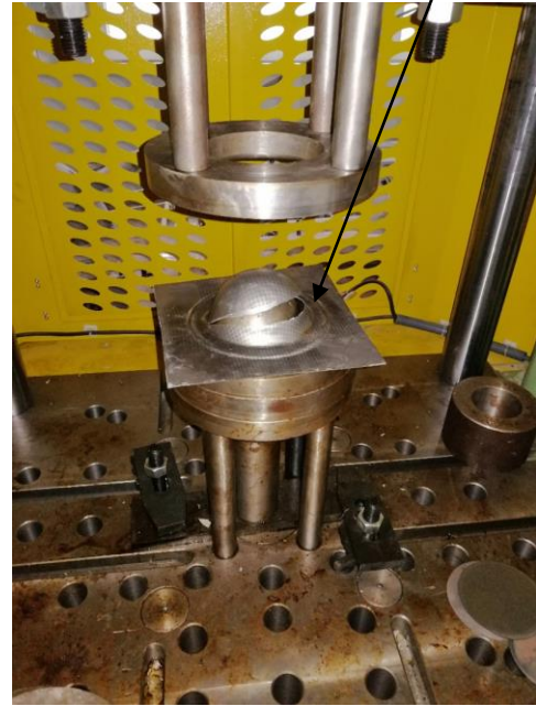
Şekil 6.11. Düzlem dışı gerdirme testi (a) Kalıp elemanları (b) Kalıp kapalı durum (c) Yırtılan numune
