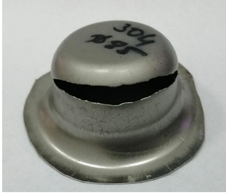
Şekil 4.8. Derin çekme sonrası yırtılma hasarına uğramış sac parça
