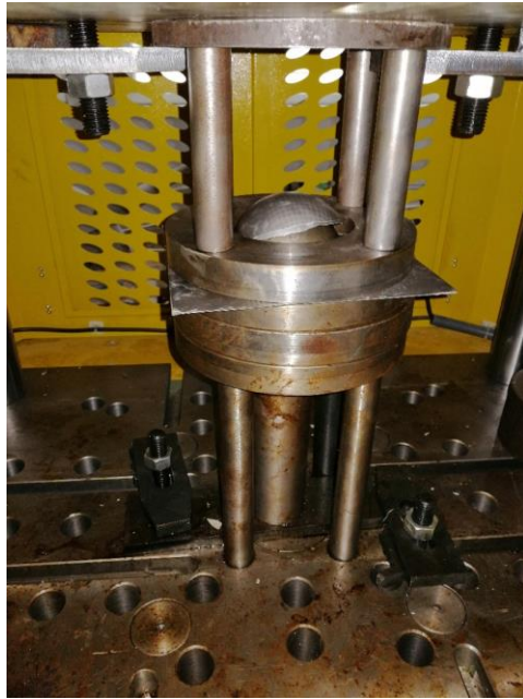
Şekil 6.11. Düzlem dışı gerdirme testi (a) Kalıp elemanları (b) Kalıp kapalı durum (c) Yırtılan numune
