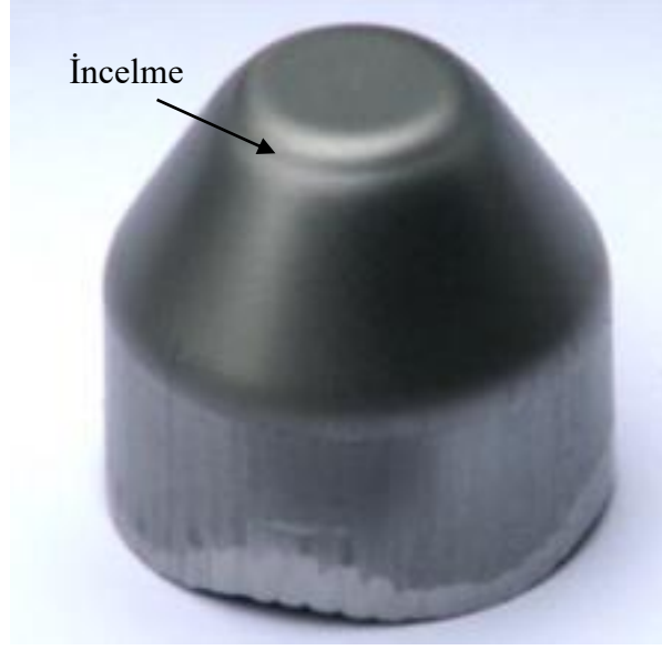
Şekil 4.10. Yerel incelme oluşmuş derin çekme ürünü (Bakhshi-Jooybari vd., 2012)
