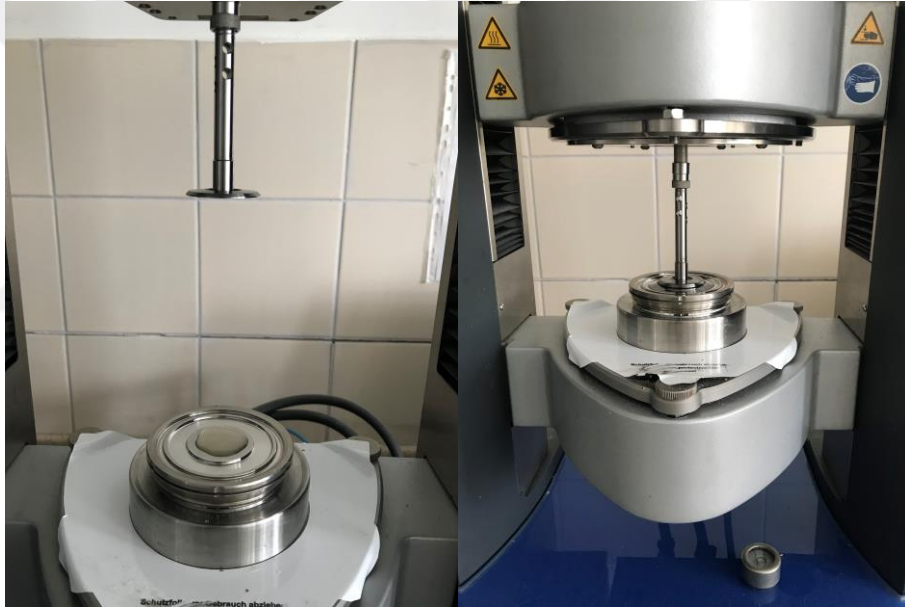
Şekil 2.3 Reoloji cihazına konulan agar örnekleri
