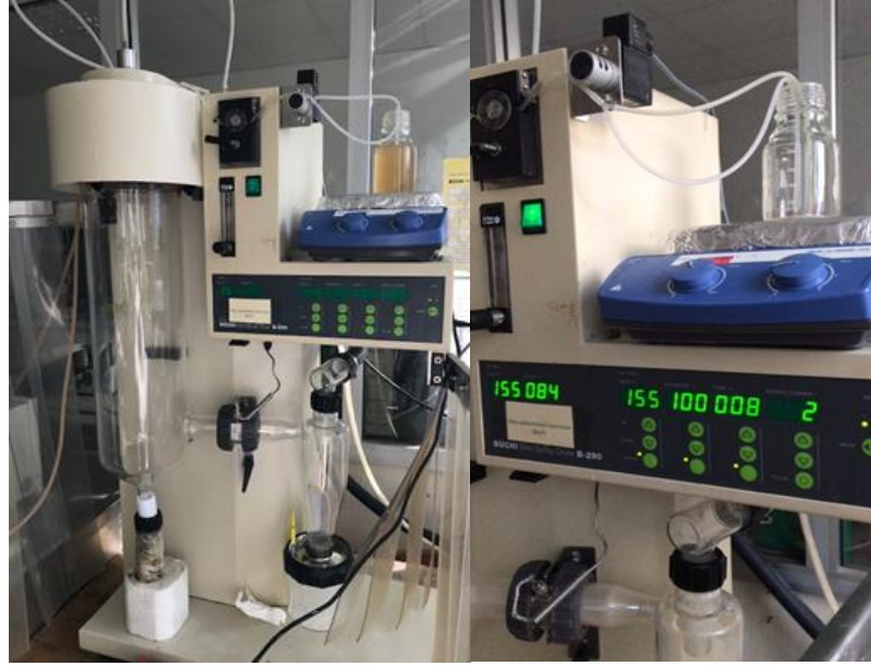
Şekil 2.2 Spray dryera verilmiş agar ekstraktı ve sıcaklık-pompa değerleri
