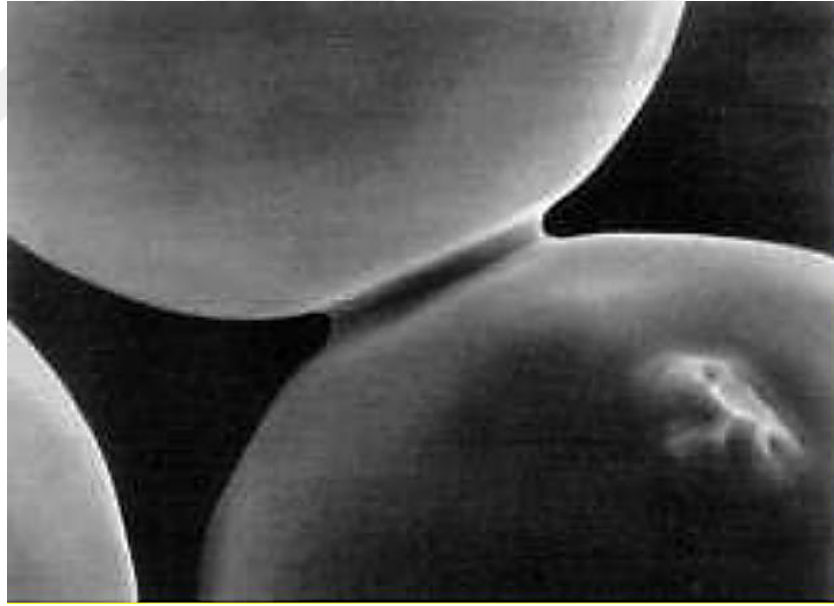
Şekil 4.10. Sinterleme sırasında boyun oluşumu (Ayata, 2014)
