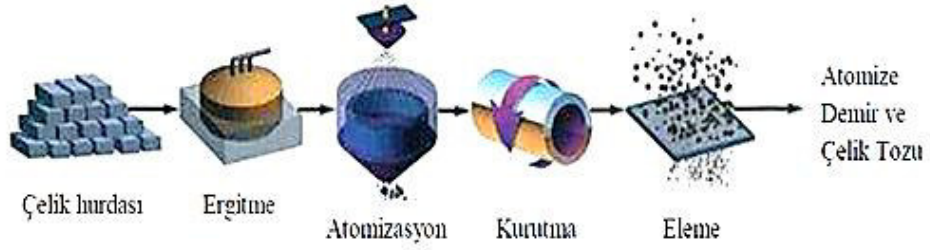
Şekil 4.4. Atomizasyon ile toz üretim aşamaları (Ayata, 2014)
