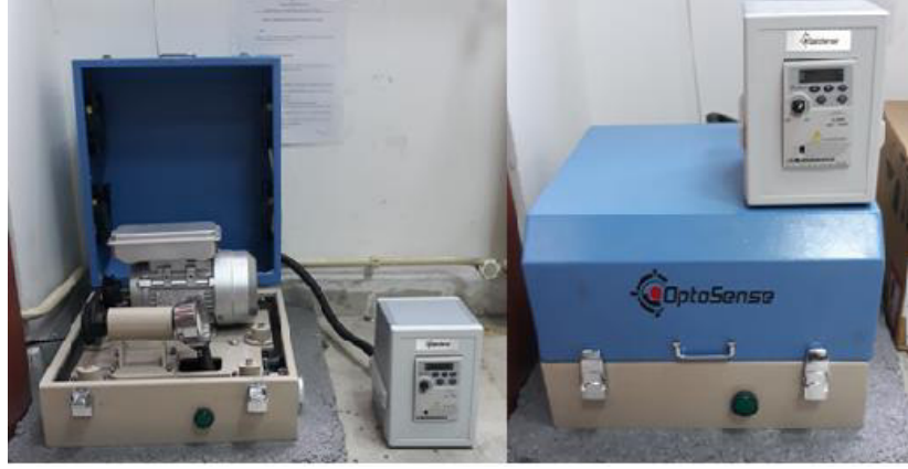
Şekil 5.4. MTI MSK-SFM-3 marka yüksek enerjili bilyeli değirmen
