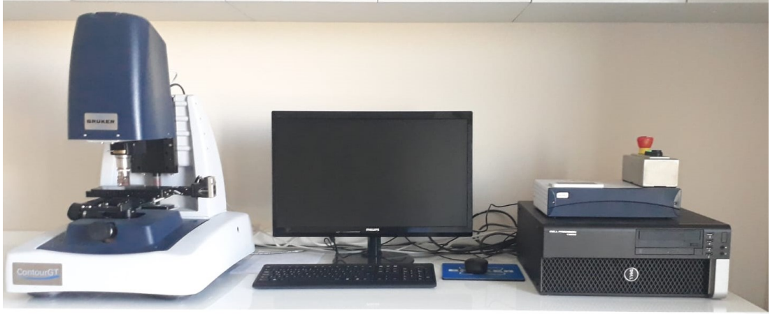
Şekil 4.15. 3D pürüzlülük ölçüm cihazı
