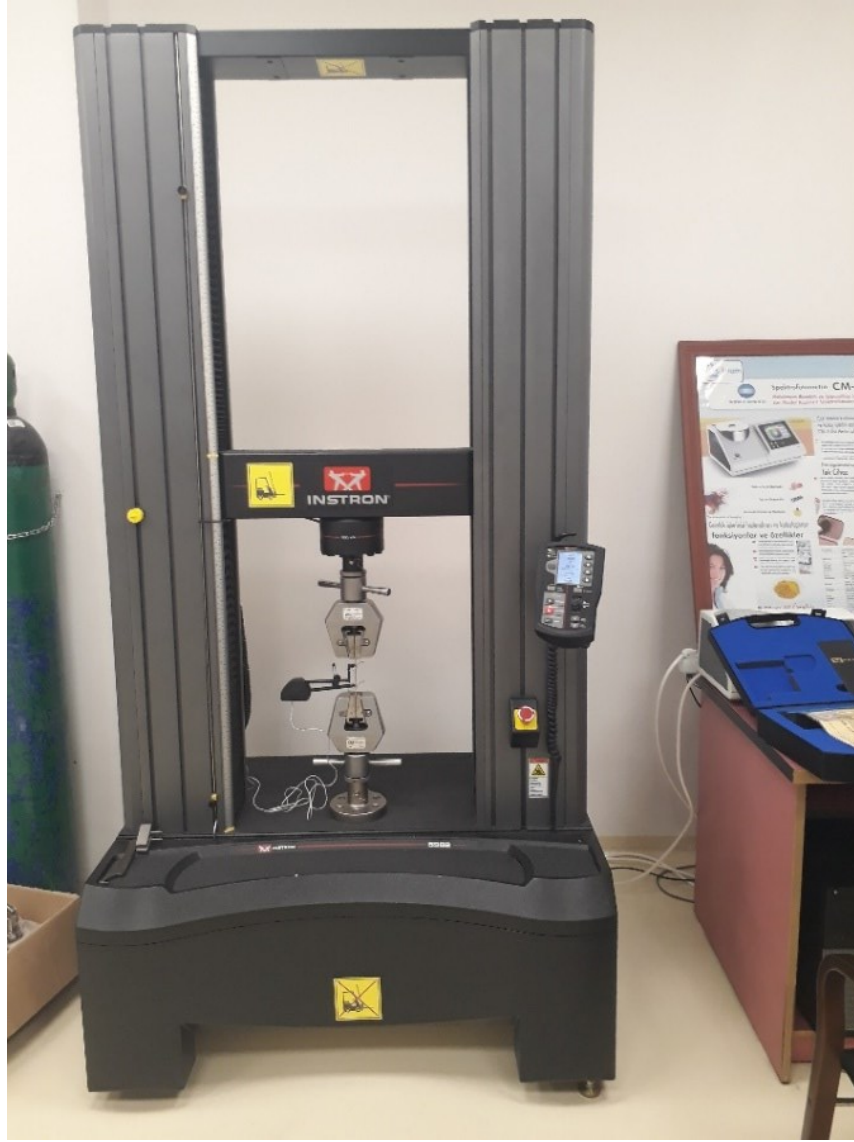
Şekil 4.3. Çekme özelliklerini tayin etmek amacıyla kullanılan üniversal çekme cihazı
