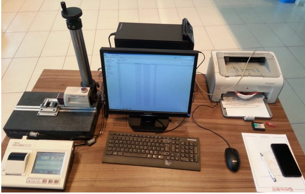
Şekil 4.12. Merdane pürüzlülük ölçümlerinde kullanılan pürüzlülük ölçüm cihazı
