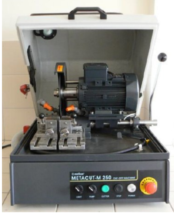
Şekil 4.16. Malzemelerin kesilmesinde kullanılan metal kesme cihazı
