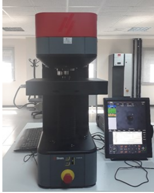
Şekil 4.21. Vickers mikrosertlik ölçüm cihazı
