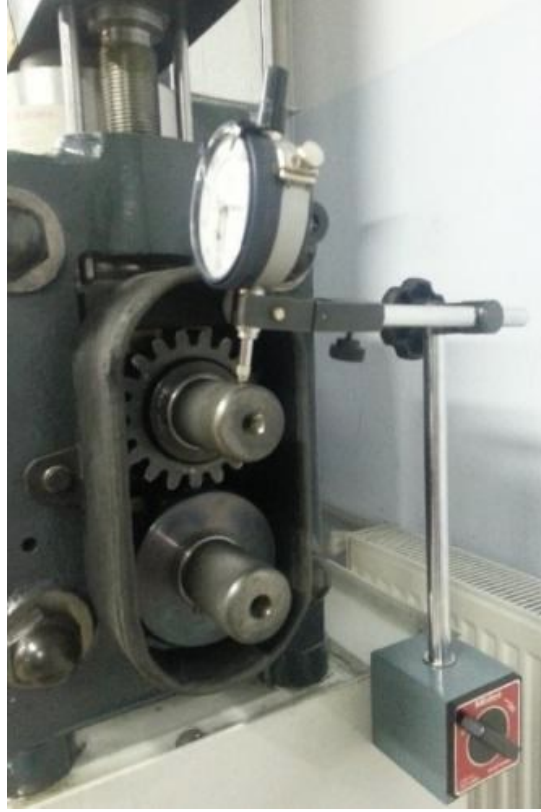
Şekil 4.10. Komparatör saati yardımıyla ezme miktarının hassas ayarlanması
