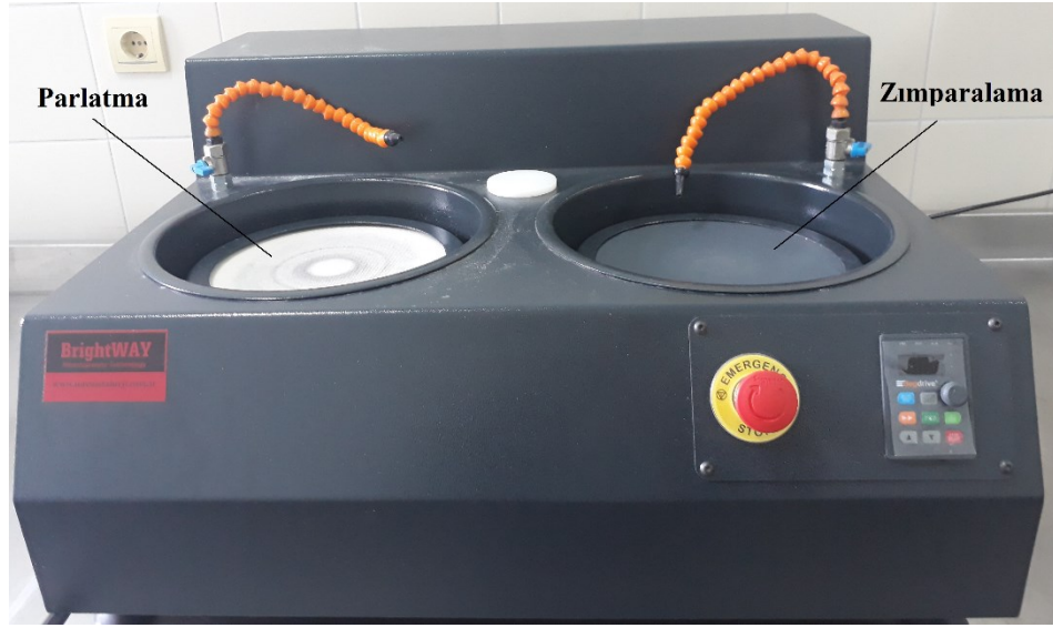
Şekil 4.19. Numunelerin hazırlanmasında kullanılan zımparalama ve parlatma cihazı
