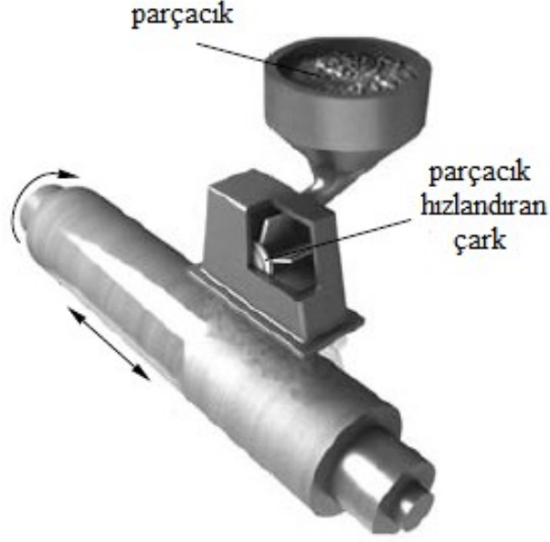
Şekil 2.20. Kumlama ile pürüzlendirme (SBT) yöntemiyle merdane yüzeyinin pürüzlendirilmesi (Gorbunov vd., 2009)
