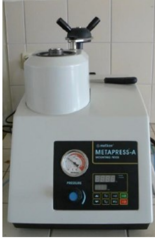
Şekil 4.17. Malzemelerin kalıplanmasında metalografik kalıplama presi
