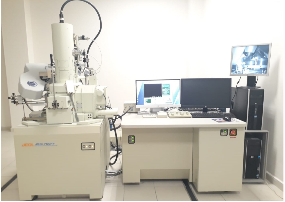
Şekil 4.22. Taramalı elektron mikroskobu (SEM)
