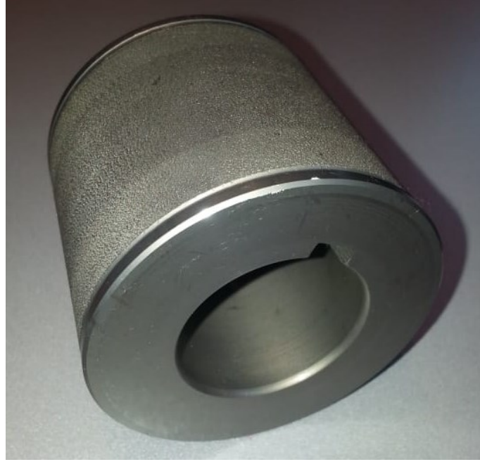
Şekil 4.6. Pürüzlendirme amacıyla üretilen pürüzlü merdane
