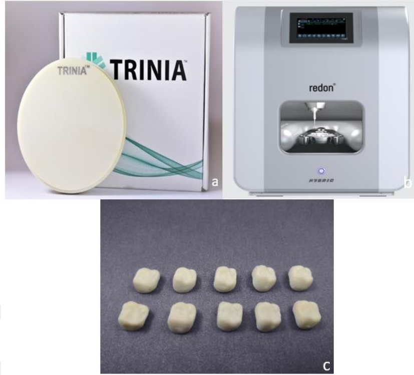
Resim 3.11. FRC kronların hazırlanması. a.FRC disk b. Kazıma cihazı c. FRC kronlar
