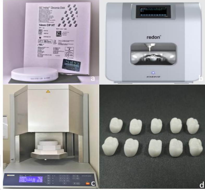
Resim 3.10. Zirkonya kronların hazırlanması. a. Zirkonya disk b. Kazıma cihazı c. Sinterleme fırını d. Zirkonya kronlar
