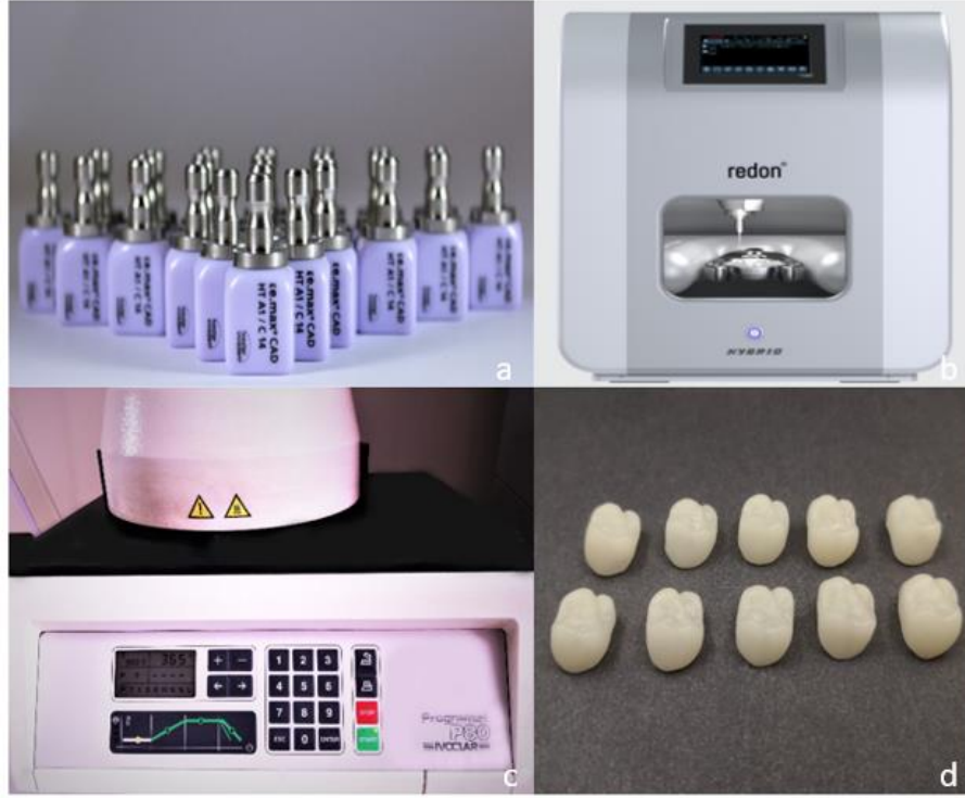
Resim 3.9. Lityum disilikat kronların hazırlanması. a. Lityum disilikat bloklar b. Kazıma cihazı c. fırınlama işlemi d. Lityumdisilikat kronlar
