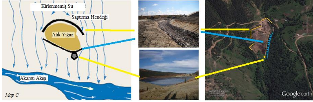
Şekil 2.11. Yüzeş akış suyunun saptırılması ve toplanması (Colorado, 2002'den türetilen Harita C)
