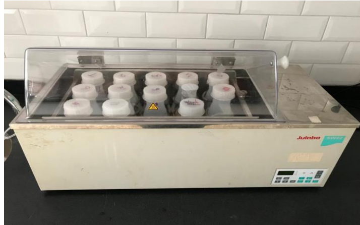
Şekil 3.2. Ekstraksiyon sıvısı eklenmiş toprakların çalkalanması
