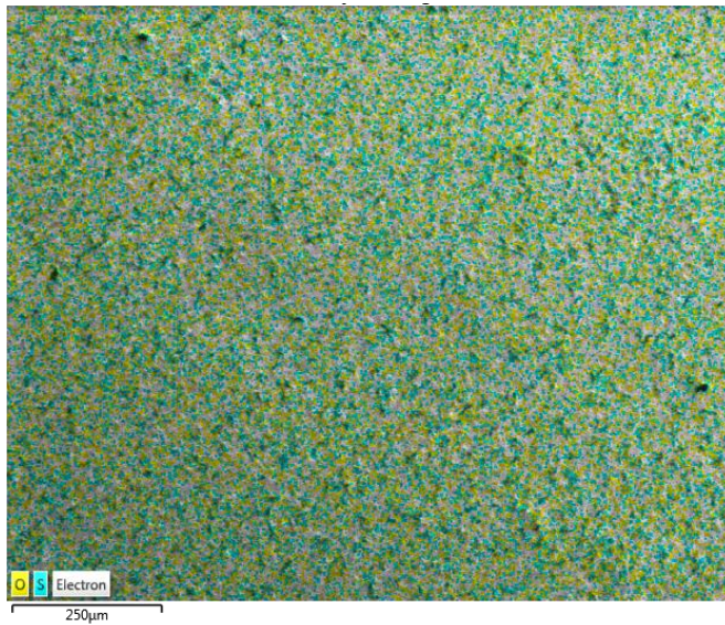
Şekil 4.6. S-PVDF-CSA membranın SEM-EDS görüntüsü (Kükürt elementi dağılımı)
