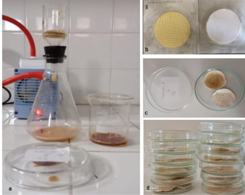
Şekil 4.5. Filtreleme işlemi (a. Süzme işlemi düzeneği, b. Süzme işleminde kullanılan filtre kağıtları, c-d. petri kaplarına yerleştirilen filtre kağıtları)
