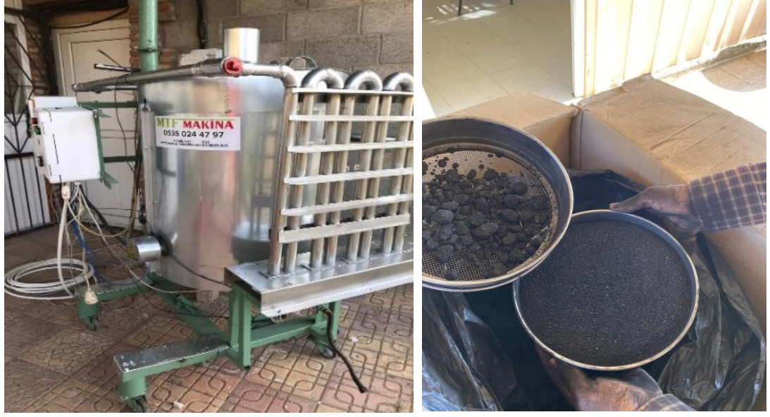
Şekil 3.4. Kesikli pirolizer (biyokömür reaktörü) ve üretilen biyokömür
