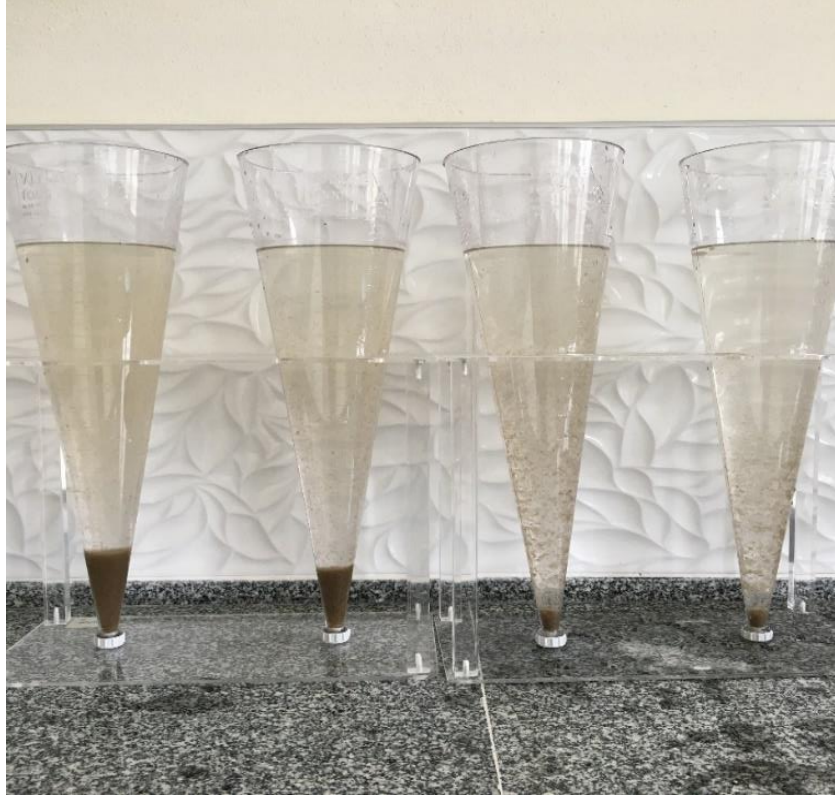
Şekil 3.20. Çamur çökelme hızı ölçümü (24.03.2022)
