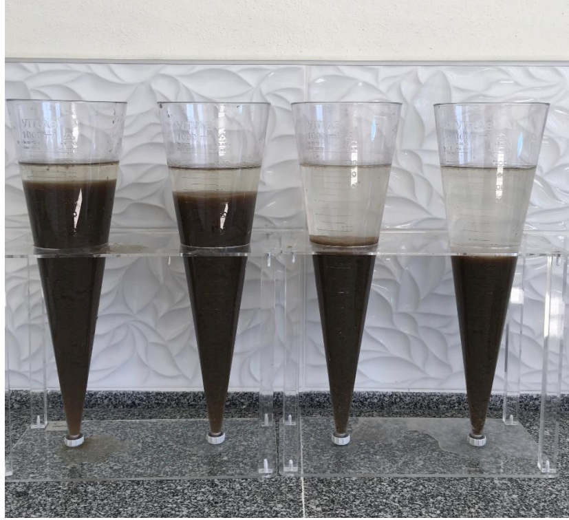
Şekil 3.22. Çamur çökeltme hızı ölçümü (7.04.2022)
