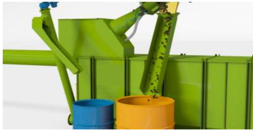
Şekil 3.7. İnce Izgara Ünitesi (Anonim, 2019b)
