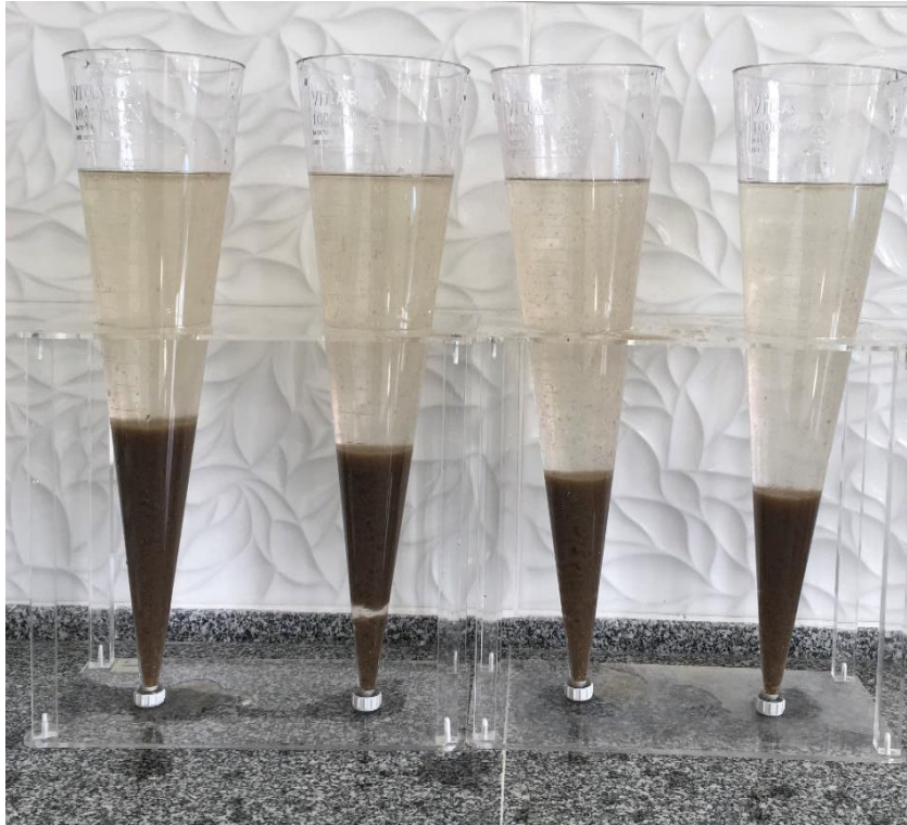
Şekil 3.21. Çamur çökelme hızı ölçümü (31.03.2022)
