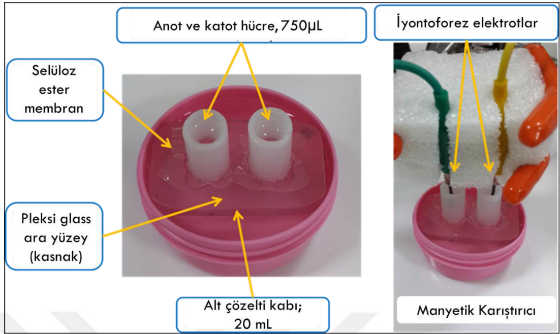
Şekil 4.17. Deneysel çalışmalarda kullanılmak üzere tasarlanmış ve kurulmuş ters-iyontoforez hücresi
