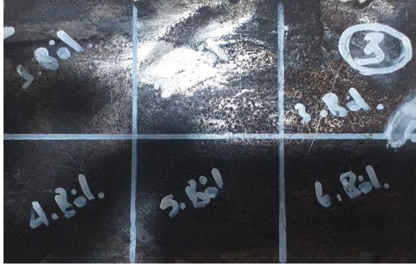
Şekil 6.8. 3 numaralı aşınmış Hardox plaka sertlik ölçüm numunesi
