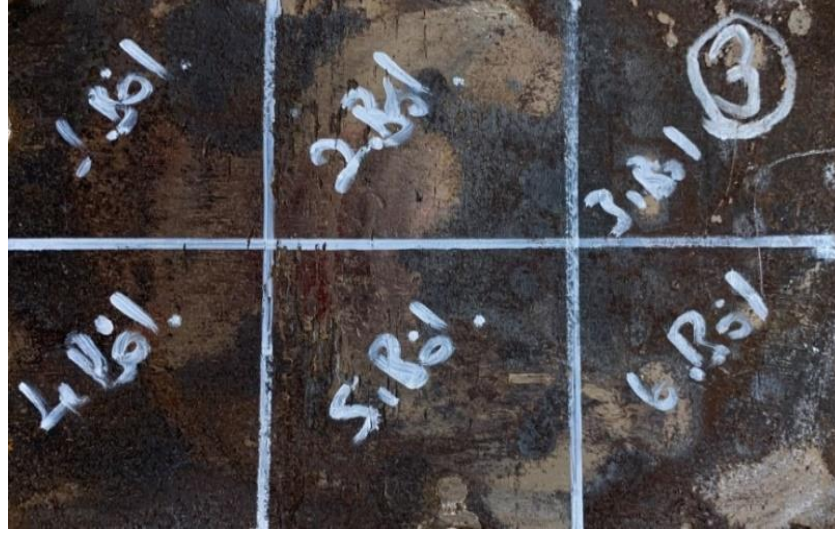
Şekil 6.5. 3 Numaralı aşınmış manganlı plaka sertlik ölçüm numunesi
