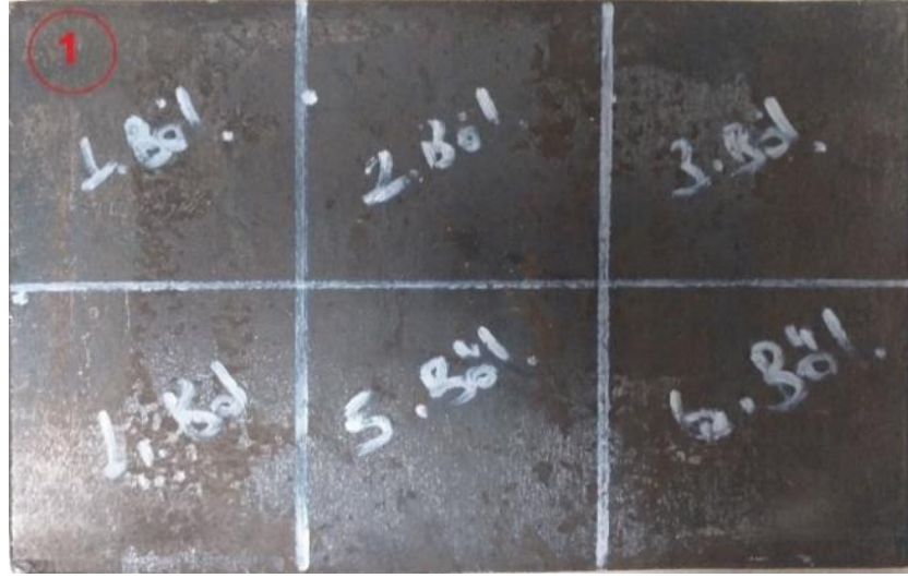
Şekil 6.1. X120Mn12 plaka sertlik ölçüm numunesi
