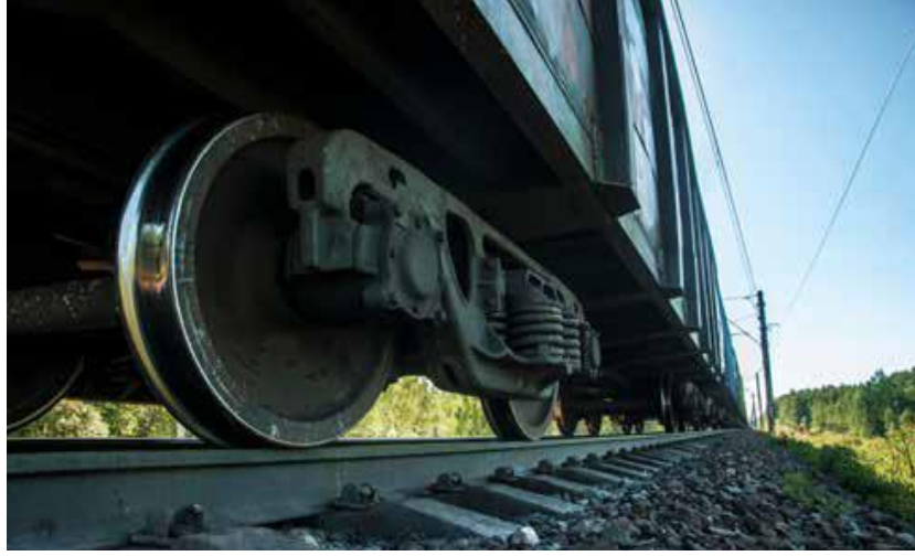
Şekil 3.3. Östenitik manganlı çeliklerin kullanıldığı vagon bojisi
