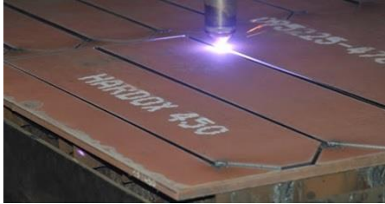
Şekil 3.16. Hardox 450 plazma kesim işlemi
