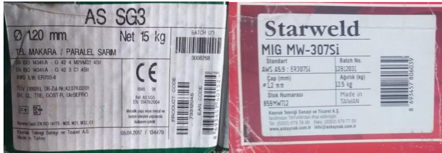
Şekil 5.17. Kaynak işleminde kullanılan gazaltı kaynak telleri
