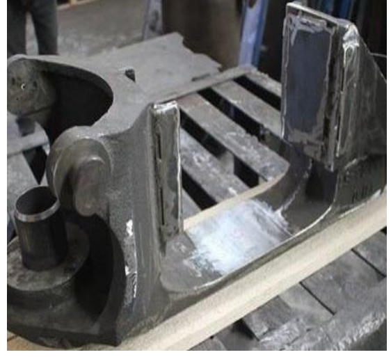
Şekil 3.11. Susta taşıyıcıyı üzerine kaynak edilen manganlı aşınma plakaları
