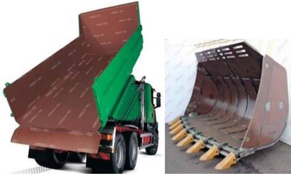
Şekil 3.15. Hardox çeliğinden imal edilmiş kamyon damperi ve kepçe
