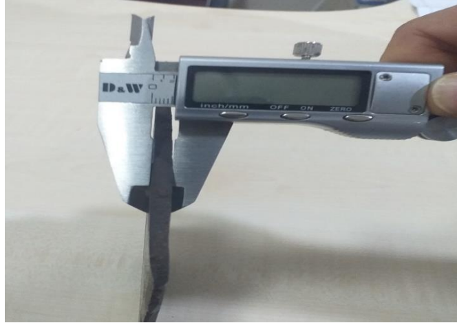
Şekil 5.19. Susta taşıyıcı üzerindeki aşınma plakası kalınlık ölçümü
