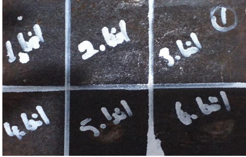
Şekil 6.6. 1 Numaralı aşınmış Hardox plaka sertlik ölçüm numunesi
