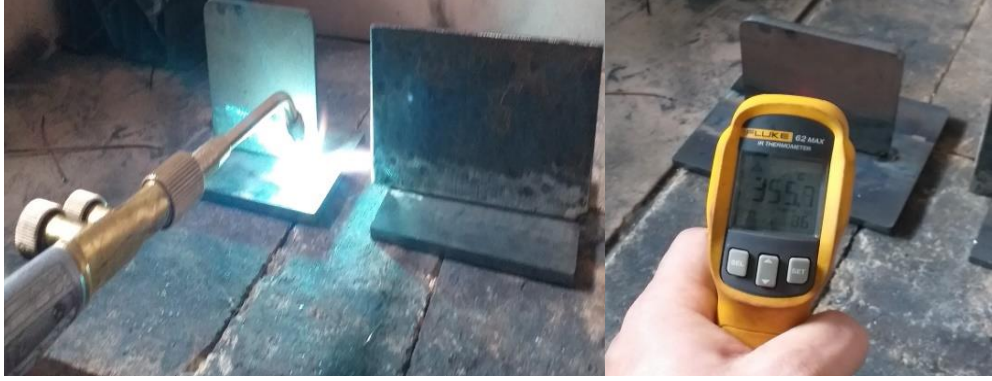
Şekil 5.16. Ön tavlama yapılan deney numuneleri
