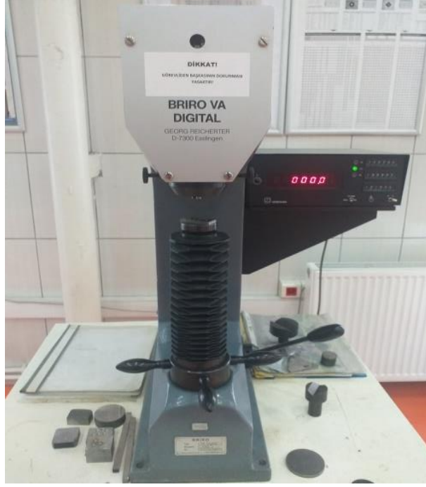
Şekil 5.4. Rockwell sertlik ölçüm cihazı
