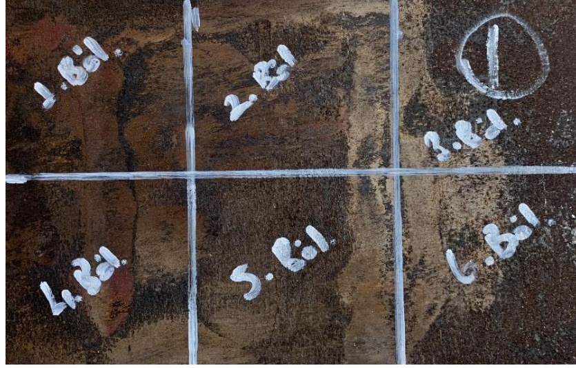
Şekil 6.3. 1 Numaralı aşınmış manganlı plaka sertlik ölçüm numunesi
