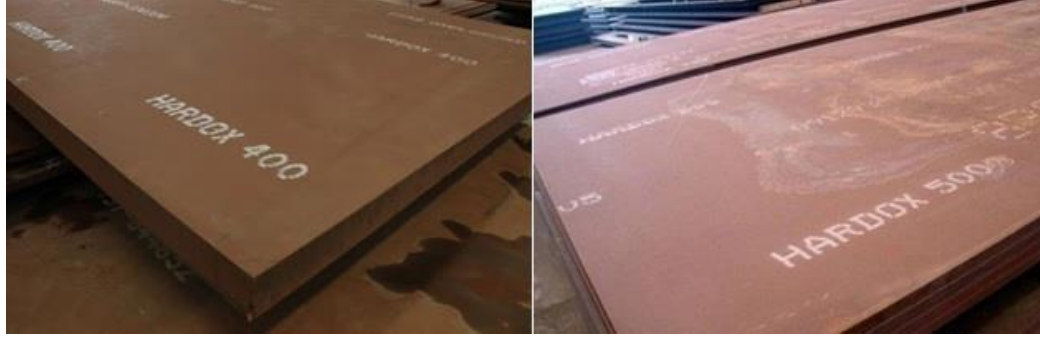
Şekil 3.13. Hardox 400 ve 500 levhaları
