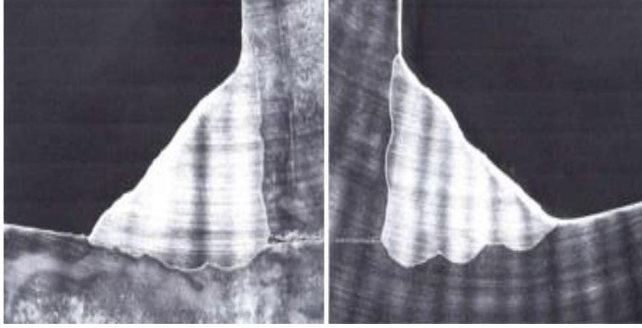
Şekil 6.21. Hardox plakaya ait makro inceleme görüntüsü
