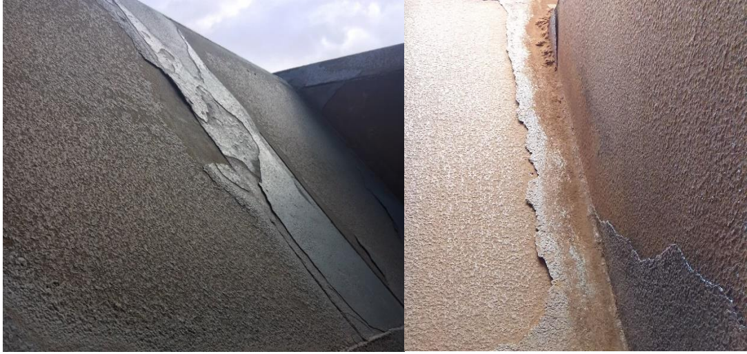
Şekil 2.12. Abrazyon sonucu aşınmış bir cevher vagonu taban sacları
