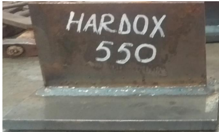
Şekil 5.15. Kaynak edilmiş Hardox plaka
