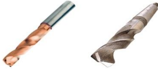
Şekil 3.17. Yüksek hız ve sinterlenmiş karbür takımlar
