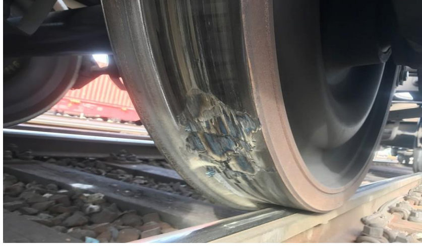
Şekil 2.7. Adhezif aşınmaya uğramış bir yük vagonu tekerleđi
