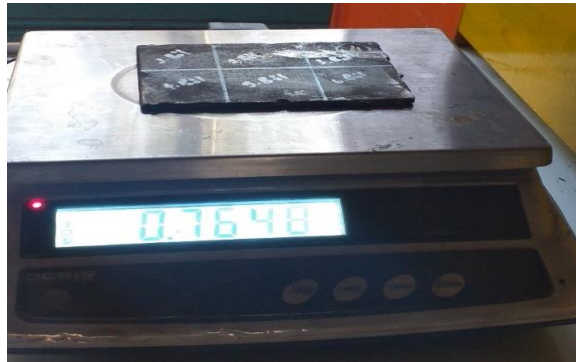
Şekil 5.13. 1/1000 hassasiyetli elektronik terazi
