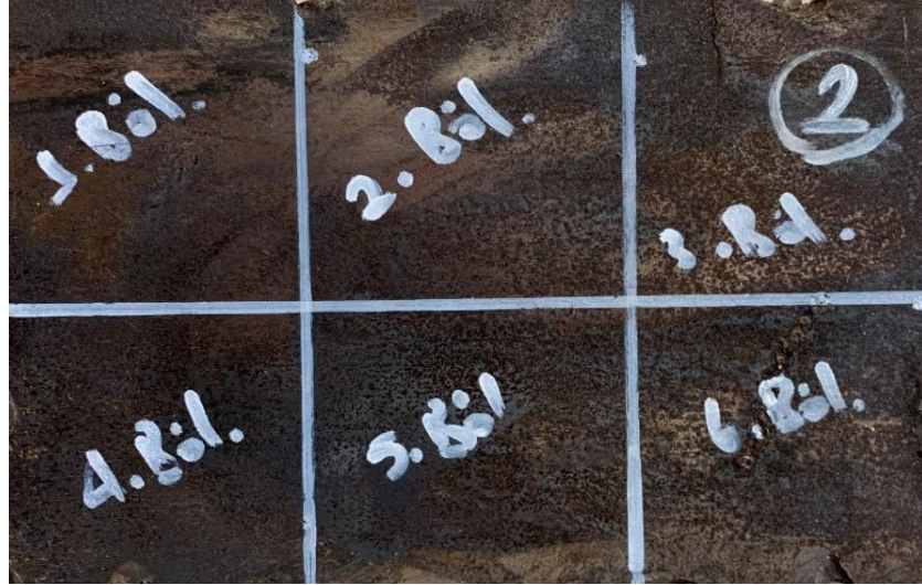
Şekil 6.7. 2 Numaralı aşınmış Hardox plaka sertlik ölçüm numunesi
