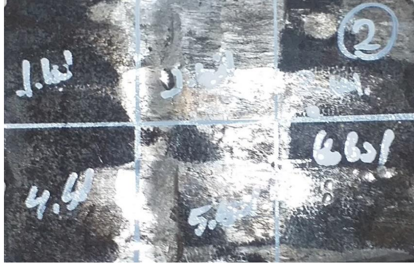
Şekil 6.4. 2 Numaralı aşınmış manganlı plaka sertlik ölçüm numunesi
