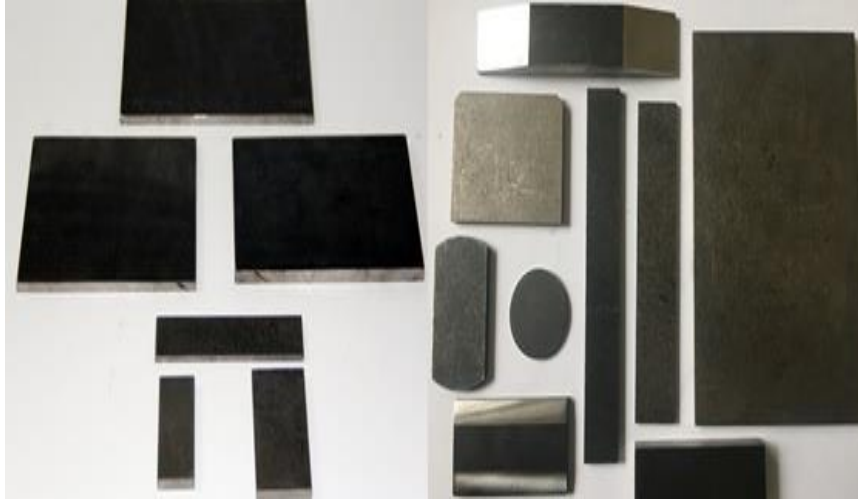
Şekil 3.8. Yük vagonlarında kullanılan manganlı çelik aşınma plakaları
