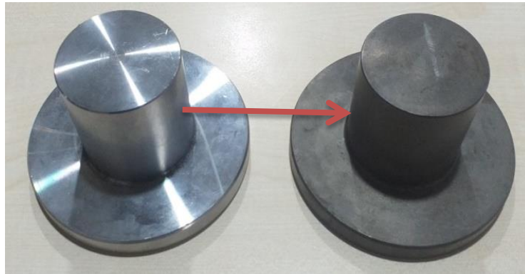
Şekil 5.11. Semente edilerek sertleştirilmiş itici
