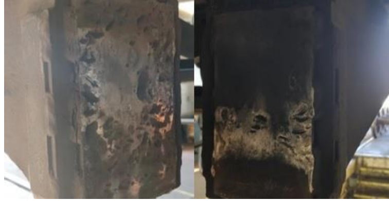
Şekil 2.9. Yük vagonu bojisindeki plakalarda oluşan adhezif aşınma örnekleri
