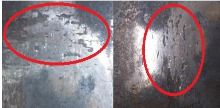
Şekil 2.8. Yük vagonlarında kullanılan adhezif aşınmaya uğramış aşınma plakalarına ait aşınma yüzeyleri
