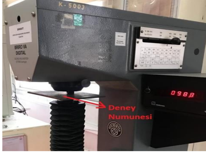
Şekil 5.6. Rockwell sertlik cihazında sertlik ölçümü
