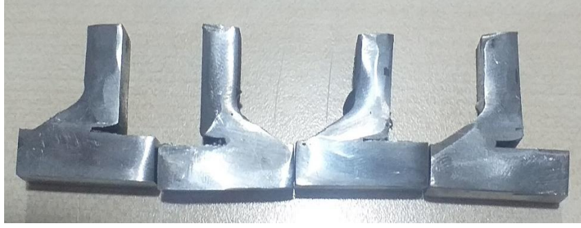
Şekil 5.18. Sertlik taramasında kullanılan kaynaklı numuneler
