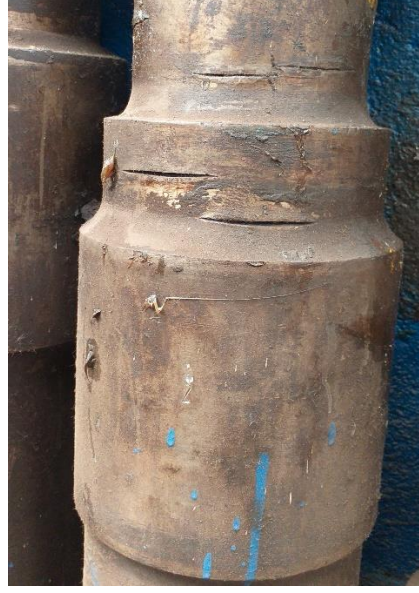
Şekil 2.15. Vagon tekerleğinin dingilinde oluşan yorulma çatlakları
