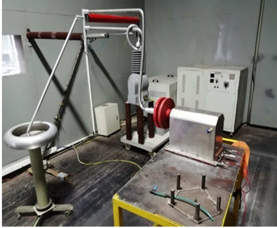
Şekil 4.35.Hava, SF6 ve R410A yalıtımlı gerilim transformatörü kısmi deşarj deney düzeneđi (ESİTAŞ Elektrik Laboratuvarı)
