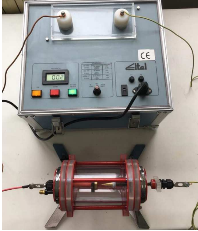
Şekil 3.9. Koni-düzlem elektrot sisteminde delinme gerilimi test düzeneği
