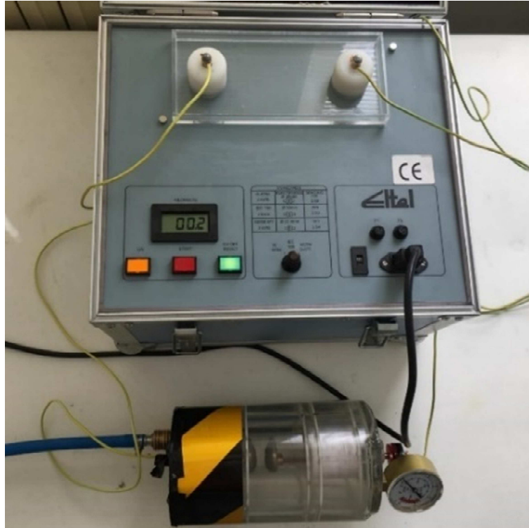
Şekil 3.5. Küresel elektrot sisteminde delinme gerilimi test düzeneği
