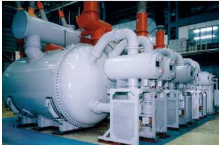
Őekil 1.2. SF6 gazlı 275 kV-300 MVA kapasiteli dnyanın ilk byk GYT'si (Yanari, 2004)
