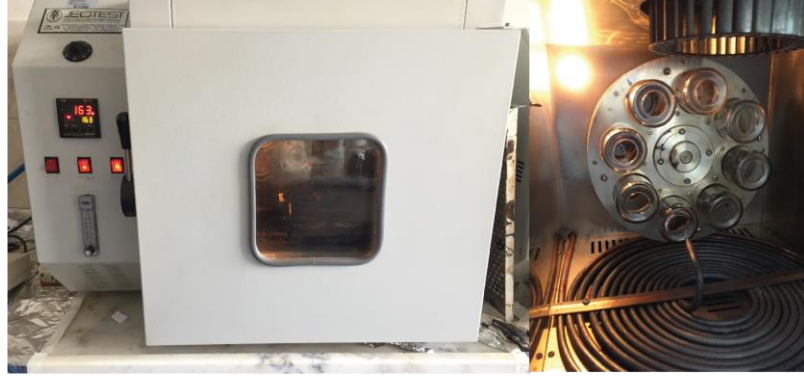
Şekil 3.26. Dönel ince film halinde ısıtma fırınının dıştan ve içten görünümü
