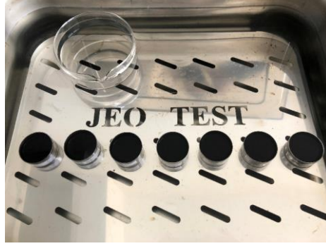
Şekil 3.7. 25°C'lik su banyosundaki bitüm numunesi dolu penetrasyon kapları ve taşıma kabı
