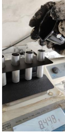
Şekil 3.31. RV tüplerine bitüm doldurma işlemi
