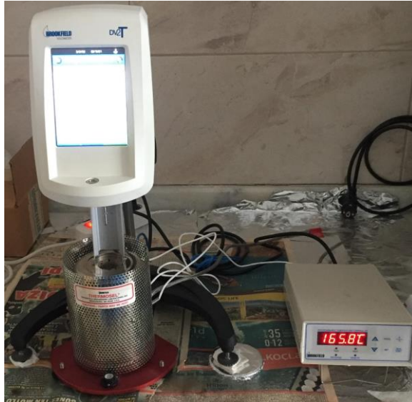
Şekil 3.30. RV cihazı ve termosel
