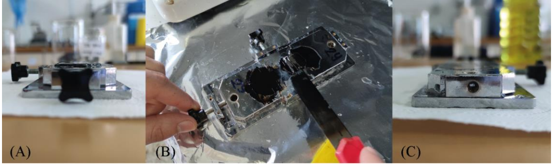
Şekil 3.14. (A) Tıraşlamadan önce kalıp yüzeyi (B) Tıraşlama işlemi (C) Tıraşlamadan sonra kalıp yüzeyi
