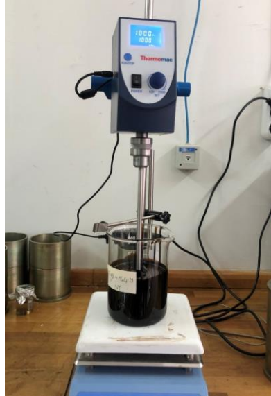
Şekil 3.5. Mekanik karıştırıcı ile modifiyeli bitüm numunelerinin hazırlanması
