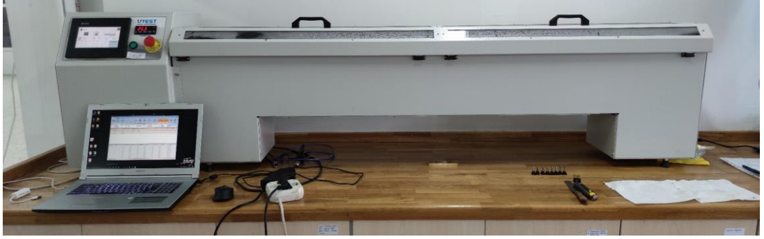
Şekil 3.12. Kuvvet ölçümlü düktilite cihazı
