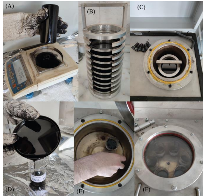
Şekil 3.29. (A) RTFO kaplarından PAV kaplarına numune aktarımı (B) PAV kaplarının numune rafına yerleştirilmesi (C) numune rafının PAV cihazına yerleştirilmesi (D) PAV sonrası numunelerin farklı kaplara aktarılması (E) Numunelerin vakum fırınına yerleştirilmesi (F) Vakum fırınında numunelerde kalan hava boşluklarının giderilmesi
