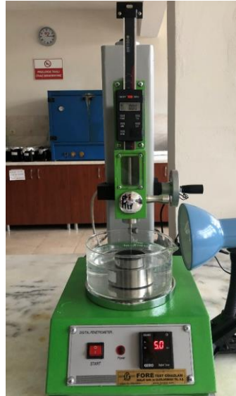
Şekil 3.6. Penetrasyon cihazı (penetrometre)
