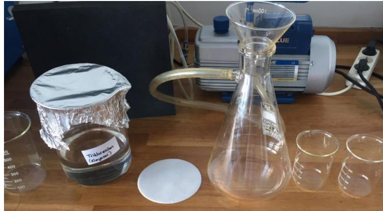
Şekil 3.20. Trikloretilende çözünürlük deneyi için kullanılan teçhizat
