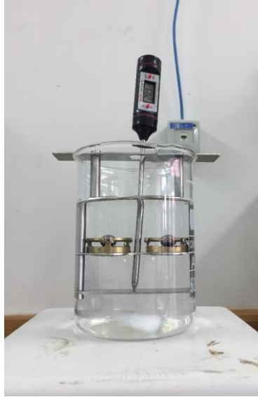
Şekil 3.9. Yumuşama noktası deney aparatı
