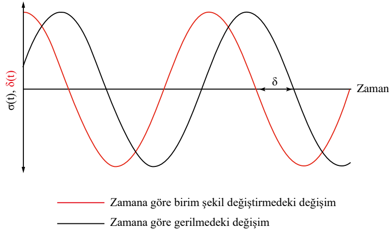
Şekil 2.25. Gerilme tepkisi ve şekil değiştirme ilişkisi (Hunter vd, 2015)
