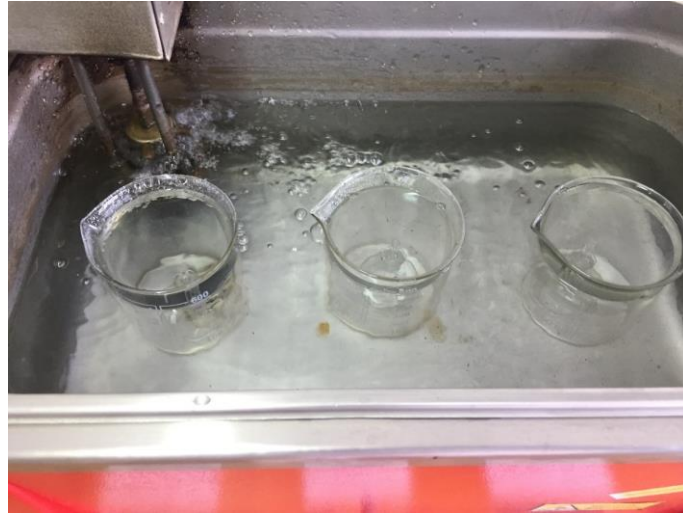
Şekil 3.24. Su banyosuna yerleştirilmiş saf su dolu piknometreler
