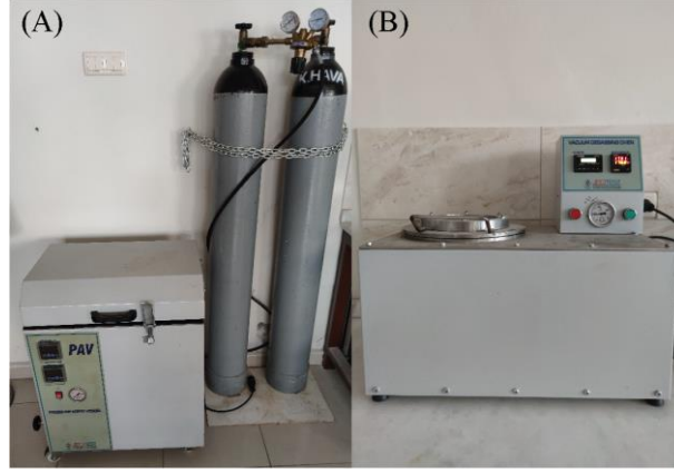
Şekil 3.28. (A) PAV cihazı, (B) Vakum fırını
