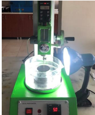
Şekil 3.8. Bir ışık kaynağı yardımı ile iğne ucunun numune yüzeyine temasının belirlenmesi
